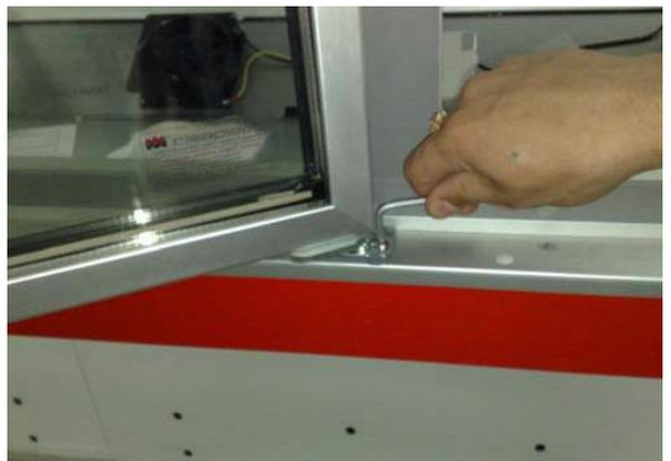
7. Установить фиксатор оси в паз, предварительно повернув ось.
