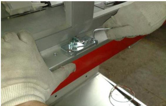
2. Вынуть фиксатор дверки.
