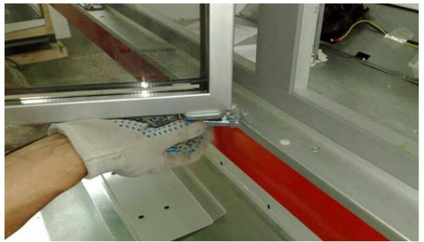
5. Вставить дверку с нижним фиксатором в раму.
