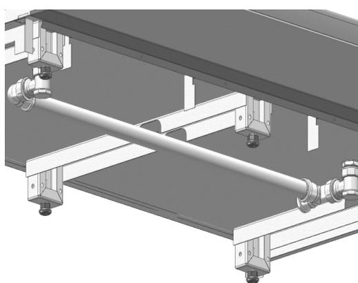
4. Нанести на места установки стоек, отступив от краев базового модуля 10 мм, силиконовый герметик. Выровнять нижние кронштейны стоек по торцам базового модуля и закрепить их при помощи саморезов 5x35.
