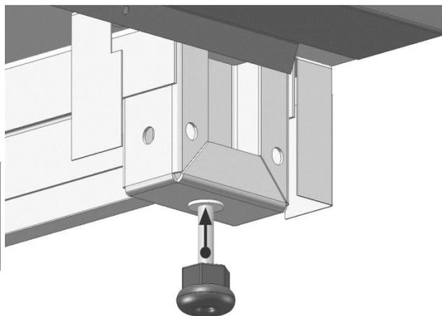
3. Собрать и установить на патрубки базового модуля систему слива. Схему расположения сливных патрубков смотри в приложении РЭ.
