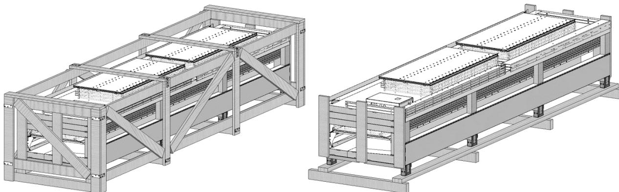
2. Снять узел базового модуля с поддона, открутив болты крепления. Вкрутить в опорные базы регулировочные ножки. Выровнять витрину по горизонтали посредством регулировки ножек и проверить выравнивание с помощью уровня.
