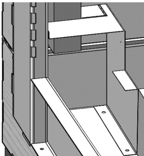
12. Установить фронтальную раму, как показано на эскизе. Закрепить раму через верхний и нижний профиль рамы к крыше и базовому модулю саморезами 5x35. Вывести кабель рамы через установленный патрубок в крыше с левой стороны. Подключить кабель рамы к блоку электроники согласно схеме в РЭ.
