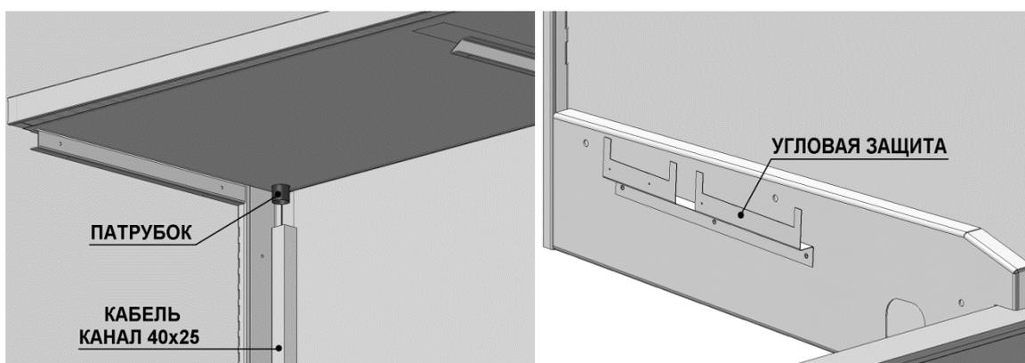
10. Уложить провода панели вентиляторов и ТЭНов в кабель-канал с правой стороны и вывести на крышу к блоку электроники. Вывести Датчики  $t$  объема и испарителя от контроллера через патрубок, далее в пластиковый кабель канал в объем витрины. Датчик  $t^0$  испарителя (с меткой на проводе) закрепить в ламелях испарителя по эскизу. Датчик объема установить на траверсе по эскизу. Патрубки в крыше замазать герметиком-замазкой.
