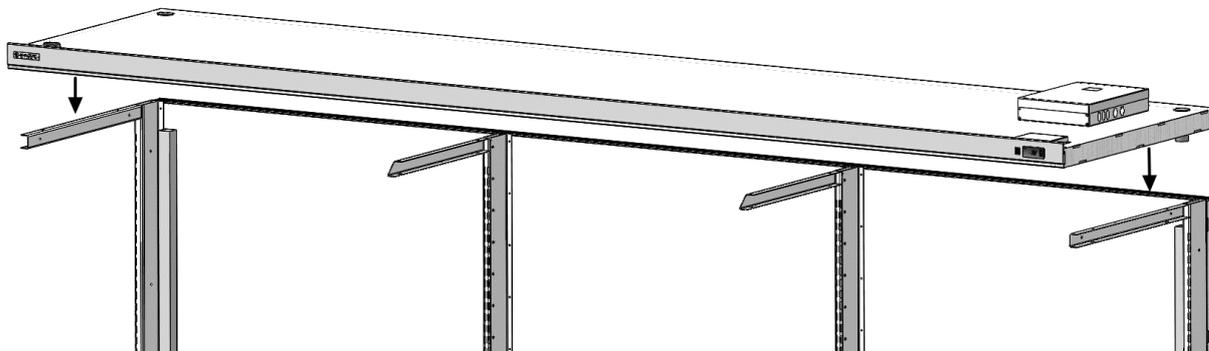
8. Установить кронштейны поддержки перфорации на задней стенке базового модуля по эскизу, закрепить саморезами 4.2x13.
