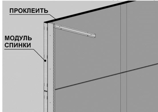
6. В качестве шаблона для установки и позиционирования центральных стоек использовать задние перфорированные стенки, зацепив их крючками за вырезы в стойках, учитывая расстояние 3-4 мм под кронштейны полок. Закрепить центральные стойки к спинкам при помощи саморезов 5x35.
