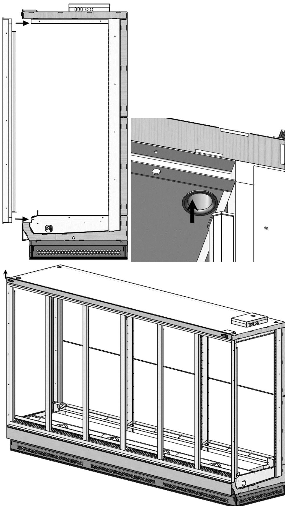
13. Перед установкой полнопрофильных боковин обклеить торцы базового модуля, спинок и крыши лентой противоконденсатной 50x3, нанести силиконовый герметик на торцы базового модуля, спинок и крыши.
