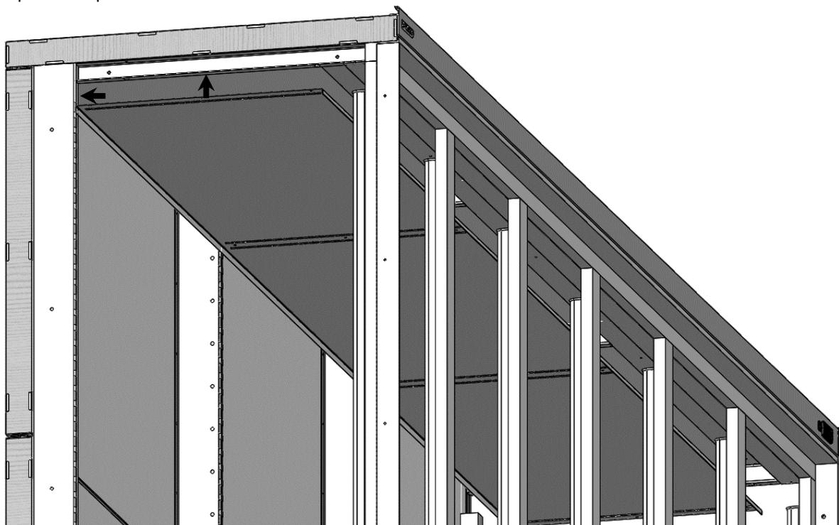
16. Установить задние перфорированные стенки в просечки стоек по эскизу.
