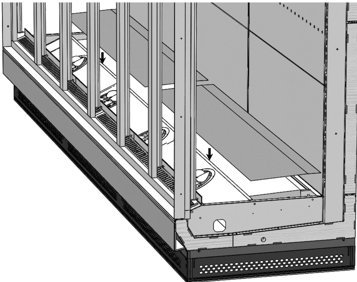
18. Установить во внутренний объем витрины основные полки. На каждую секцию 125 должна быть полка с отверстием и одна без отверстия.
