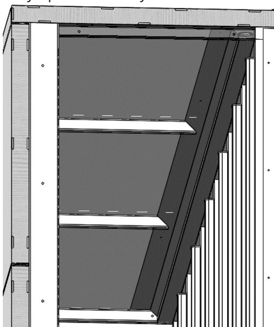
15. Завести во внутренний объем витрины панель потолка. Прижать задний отгиб панели потолка к стойкам. Закрепить к верхним кронштейнам стоек при помощи саморезов 4.2x13 со сверлом через отверстия в панели.
