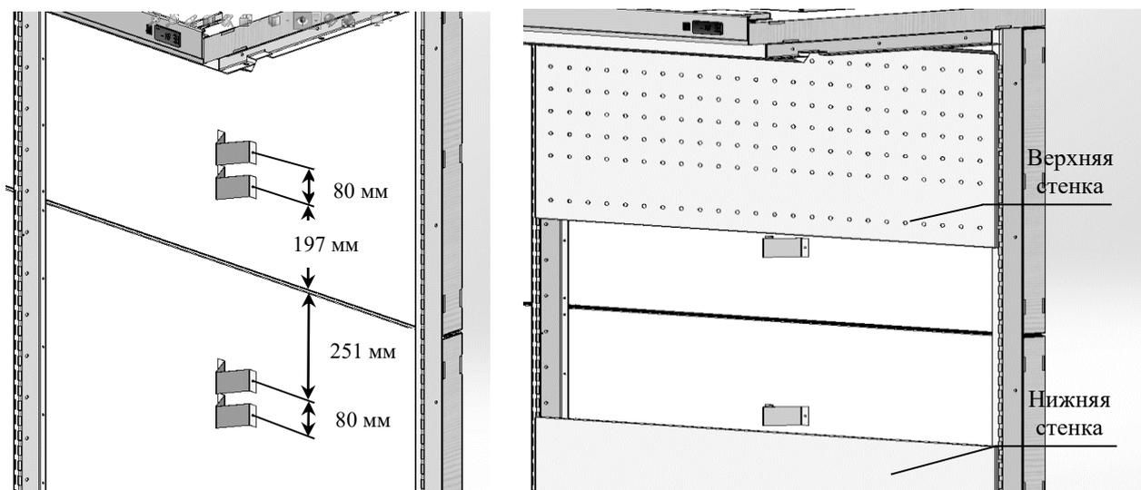
9. Установить два пластиковых кабель-канала 1550x40x25мм слева и справа на задней стенке базового модуля, закрепить саморезами 4,2x13. Установить патрубки для электропроводки в заготовленные отверстия в крыше, предварительно убрав пену. Зафиксировать патрубки накладными гайками. Установить угловую защиту кабеля по разметке на правой и левой нижней траверсе, закрепить саморезами 4,2x13 со сверлом.
