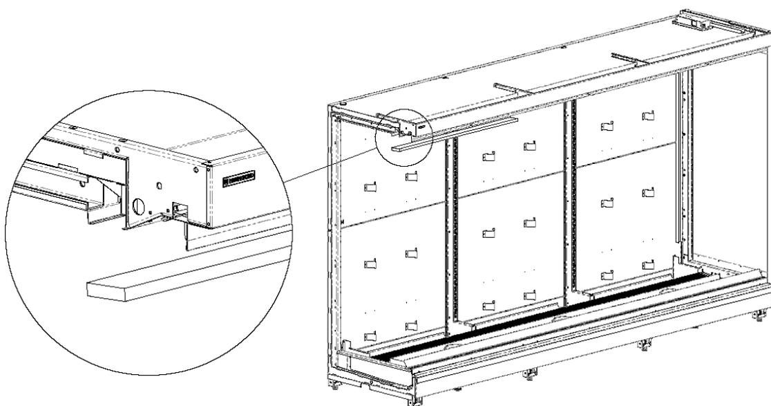
25. Установить на опоры центральных стоек, перегородки и испаритель два экрана испарителя. Завести экраны длинной стороной под панель вентиляторов. Экраны установить в притык к нижним траверсам боковых стоек.
