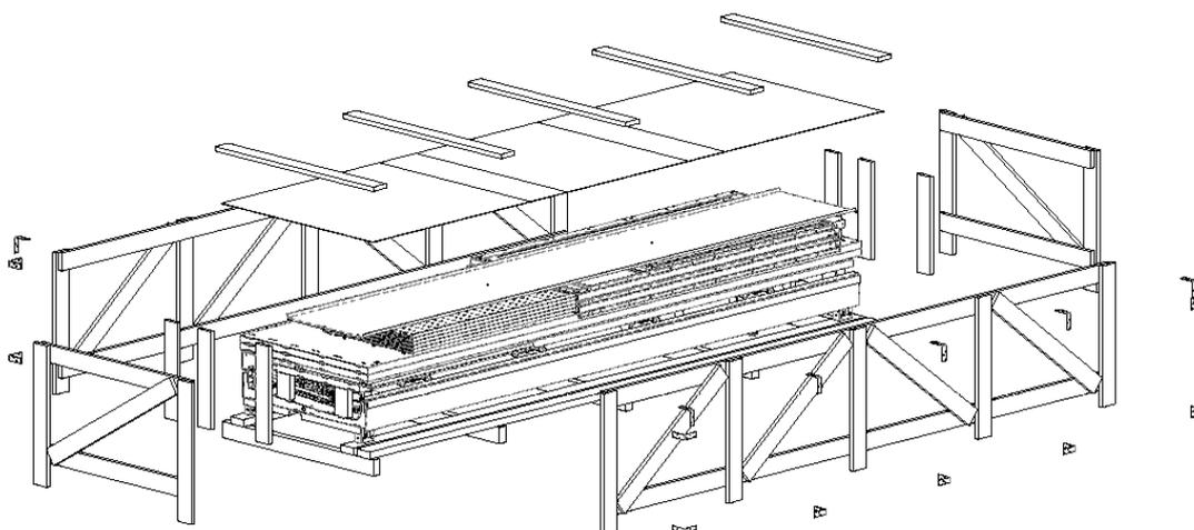
2. Снять узел базового модуля с поддона, выкрутив транспортировочные саморезы.
