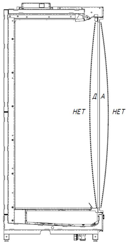
30. Соедините вертикальные стойки рам между собой при помощи винтов M5x20 с потайной головкой и резьбовых втулок из комплекта поставки.
