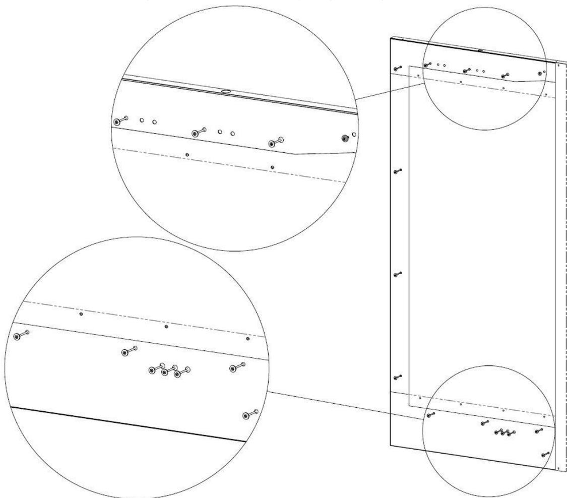
19. Позиционирование боковины произвести по нижней фронтальной панели (боковина должна выставляться на 1...3мм за декоративный бампер и быть на одной высоте с фронтальной панелью), верхнему декоративному козырьку (боковина должна выставляться за плоскость козырька на 7...9мм и быть с ним и на одной высоте), спинке витрины (торец боковины должен быть параллелен спинке витрины).
