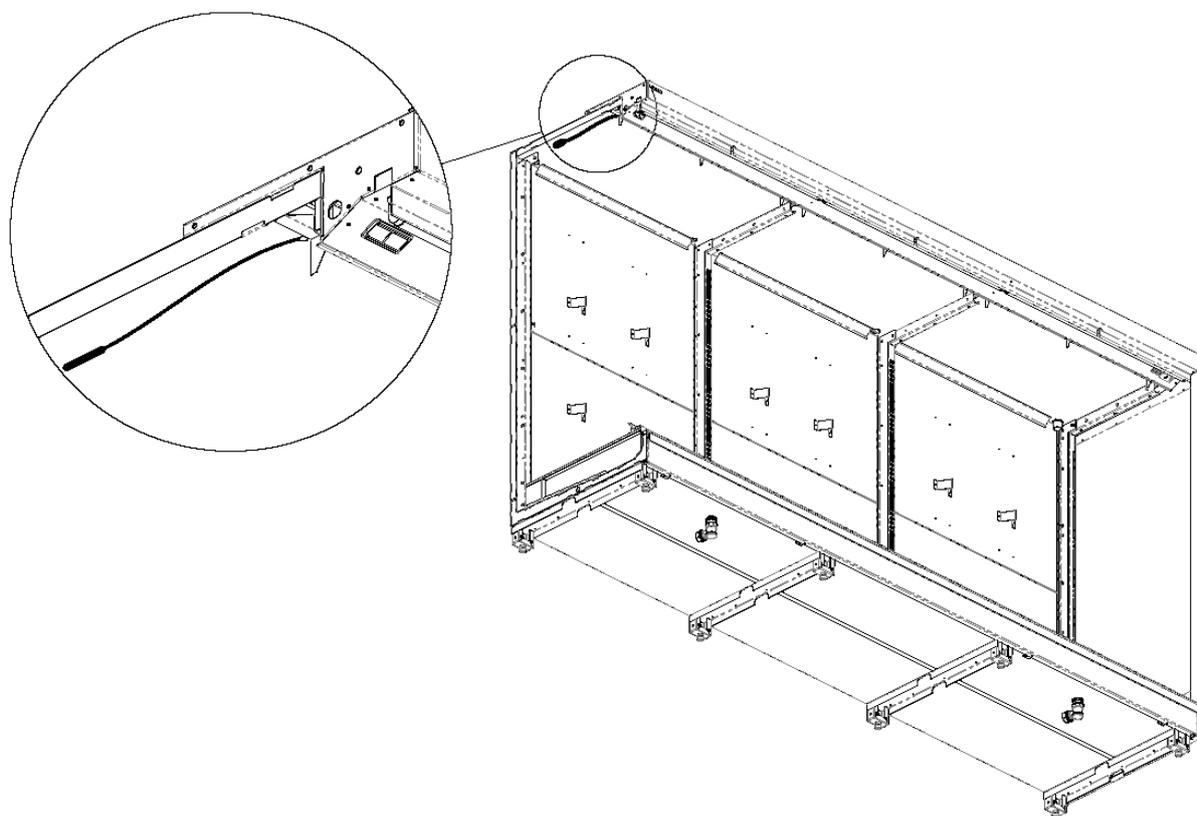
23. Завести во внутренний объем витрины панель потолка. Добиться прилегания заднего отгиба панели потолка к правой и левой боковым стойкам. Выровнять панель потолка между боковинами и закрепить к верхним кронштейнам стоек при помощи саморезов 4.2x13 со сверлом через отверстия в панели.
