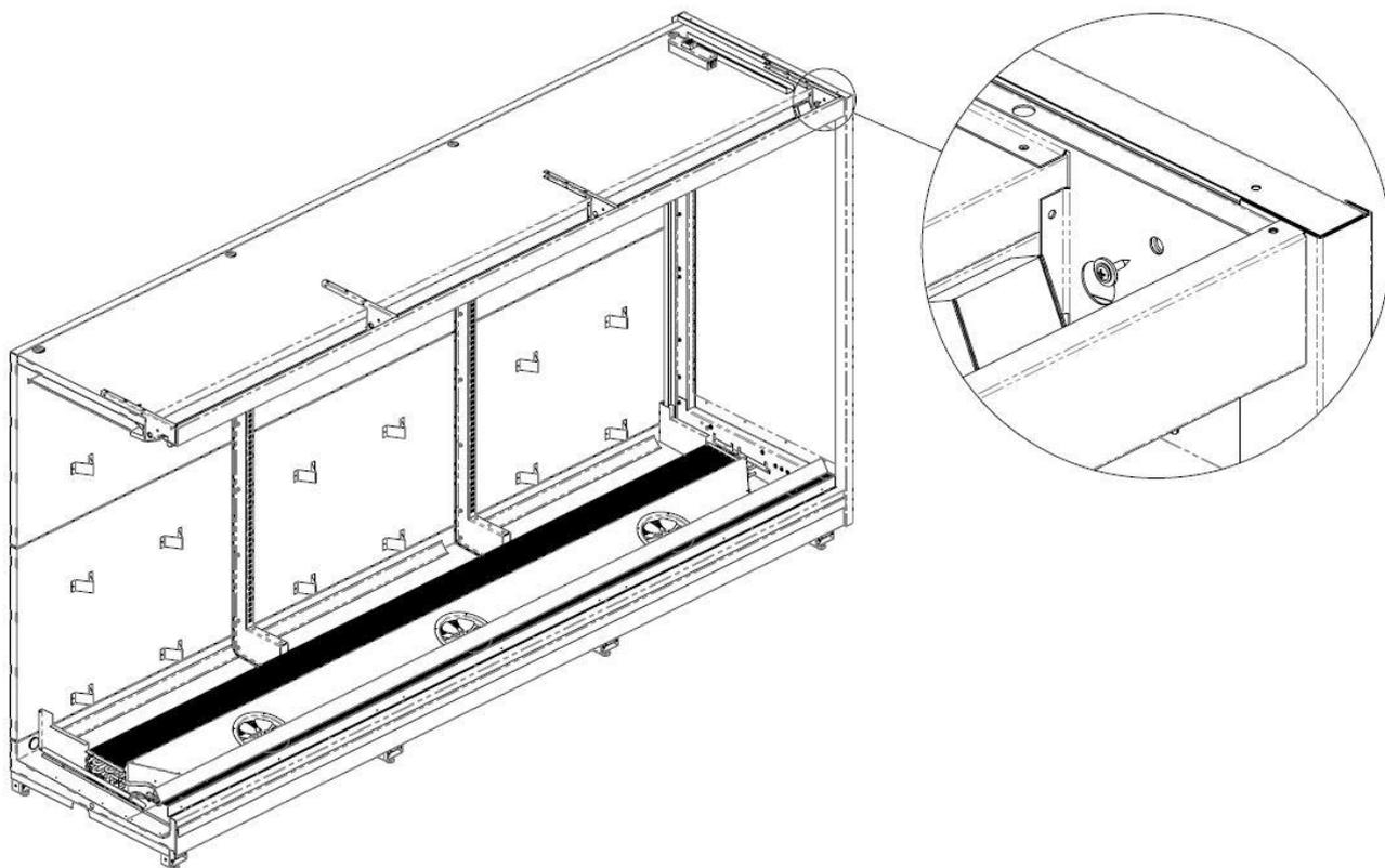
21. Стык между боковиной и спинкой промазать снаружи герметиком и закрыть задней декоративной окантовкой. Выровнять окантовку по высоте с боковиной и прикрутить при помощи саморезов 4.2x19 к спинке витрины.
