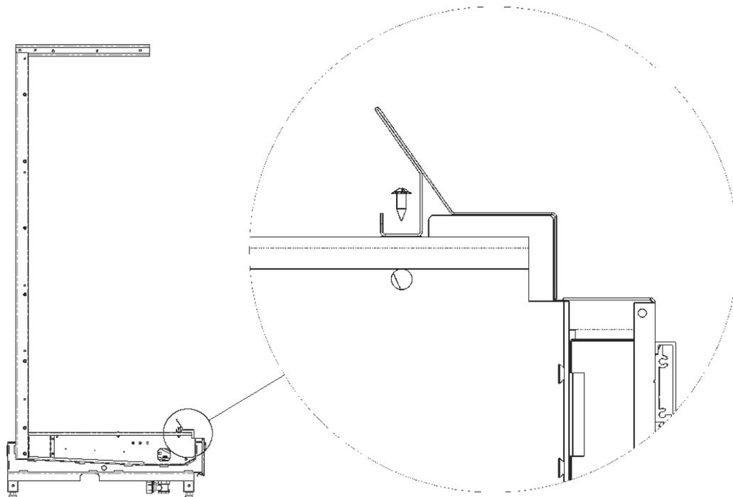
9. Обклеить торец базового модуля поролоновой лентой 30х6, входящей в комплект поставки. Установить нижнюю спинку базового модуля на торец модуля. Буква **H** при этом должна оказаться в нижнем левом углу, рядом с левой стойкой. Выровнять спинку по длине относительно базового модуля. Согласно разметке закрепить нижнюю спинку к стойкам при помощи саморезов 5х35.
