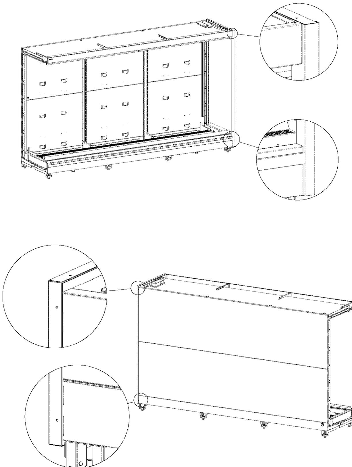
20. Закрепить боковину при помощи саморезов 5x60 и шайб 6.4x18 через отверстия в стойках, верхних и нижних кронштейнах. Крепление боковины к верхнему кронштейну козырька осуществляется саморезом 4.2x19 через шайбу 6.4x18.
