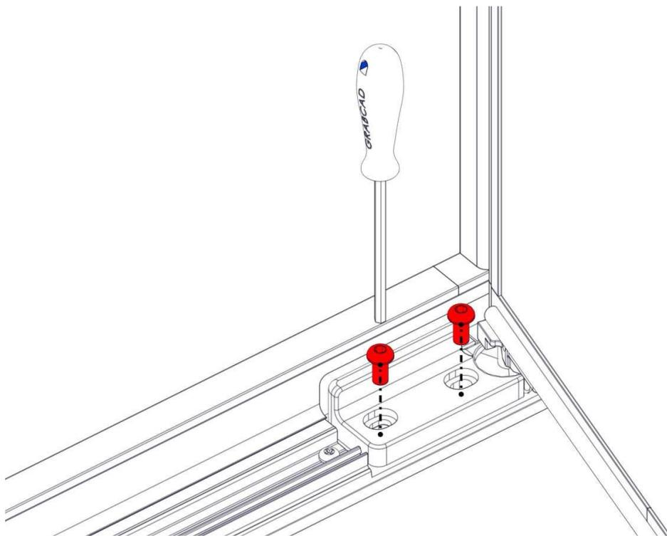
Регулировка положения двери осуществляется посредством ослабления винтов и перемещения верхней и нижней петель вдоль рамы.
