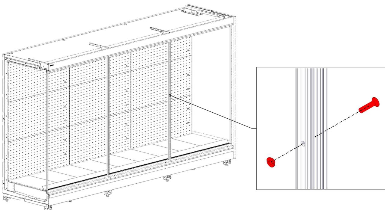
31. Перед установкой извлечь транспортировочный фиксатор. Удалить фиксатор только с внутренней стороны двери.
