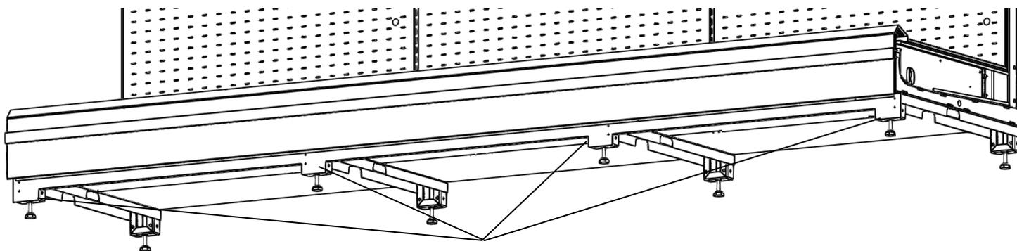
Закрепить верхнюю панель опоры саморезами 4,2x13 со сверлом
