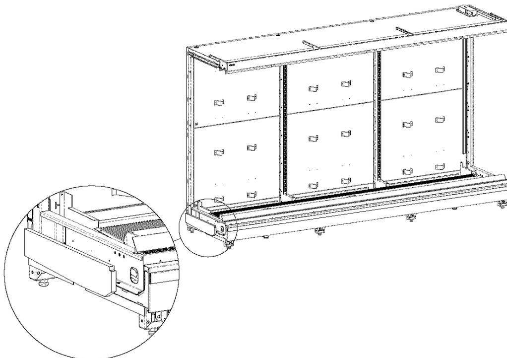
**Установка полнопрофильной боковины с зеркалом.** Боковина крепится при помощи саморезов 5х60 и шайб 6х18 через отверстия в боковых стойках. (Изображена правая боковина).
