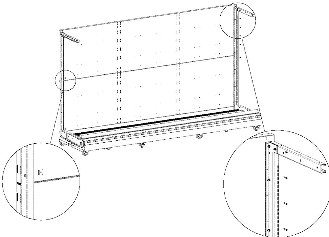
11. Монтаж центральных стоек. В качестве шаблона для установки и позиционирования центральных стоек использовать задние перфорированные стенки, зацепив их крючками за вырезы в стойках, учитывая расстояние 3-4 мм под дальнейшую установку кронштейнов полок. Закрепить центральные стойки к спинкам и базовому модулю при помощи саморезов 5х35.
