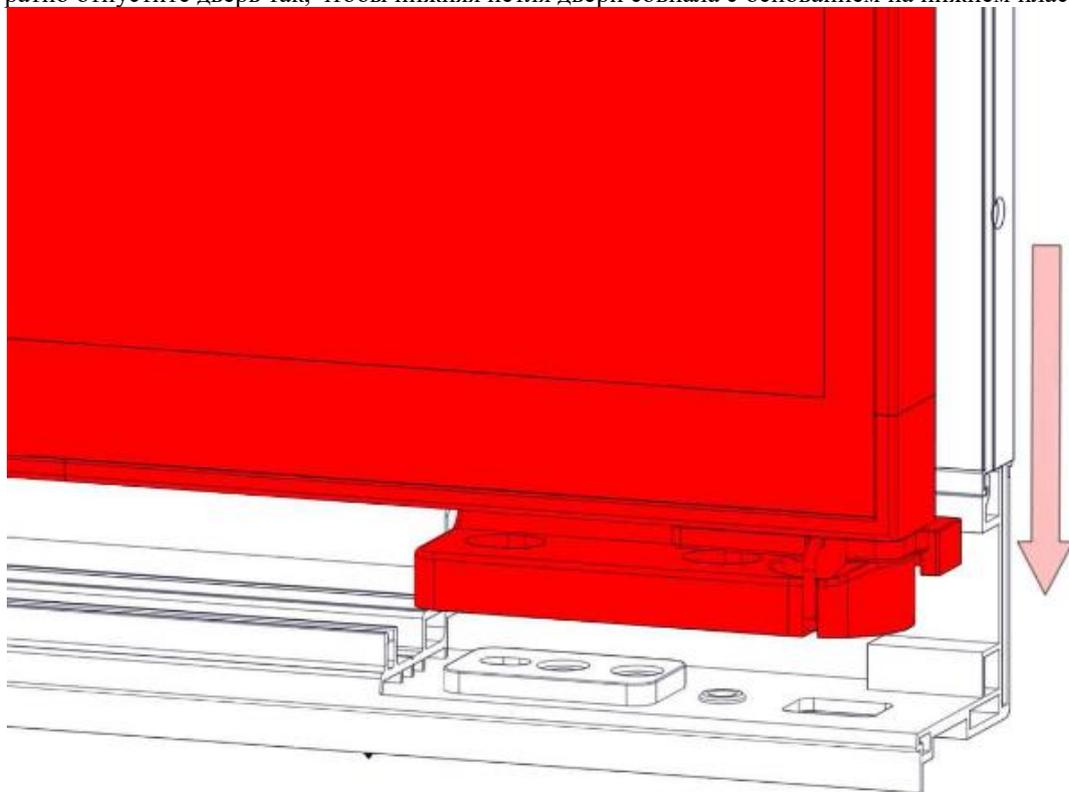
33. Закрепите нижнюю петлю на раме при помощи винтов М6Х12 из соединительного комплекта.
