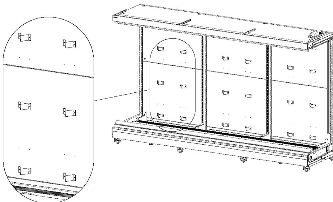
18. Обклеить торцы базового модуля, спинки и крыши поролоновой лентой 30х6, входящей в комплект поставки. Установить в нижние кронштейны стоек противоконденсатные вставки (из пенопласта), входящие в комплект поставки. Нанести силиконовый герметик на торцы базового модуля, спинки и крыши.
