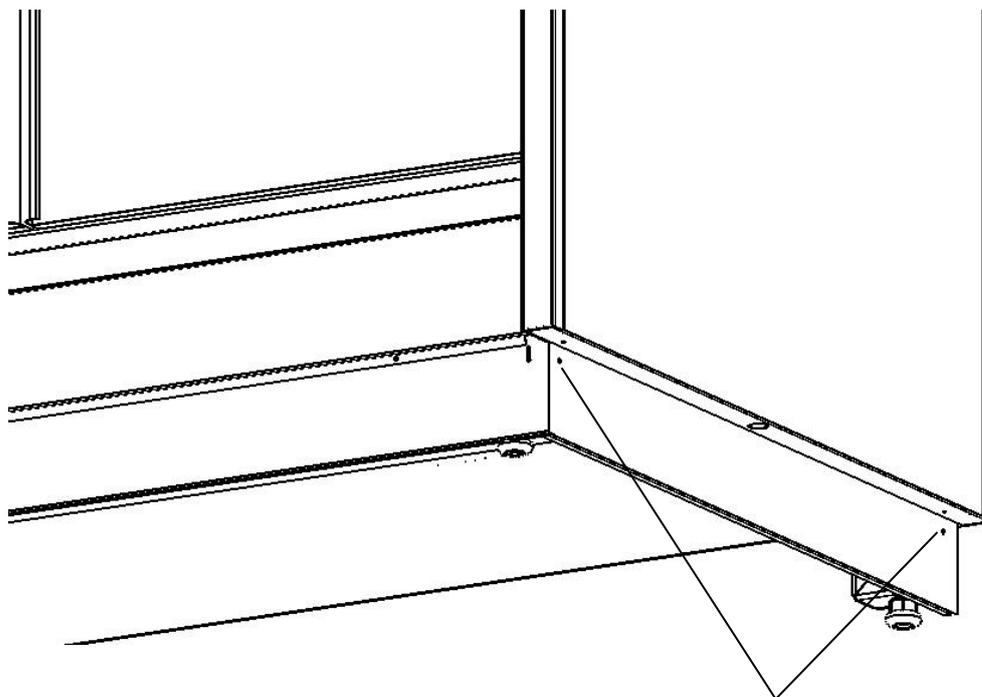
Закрепить боковую панель опоры черным саморезами 4,2x13 со сверлом
