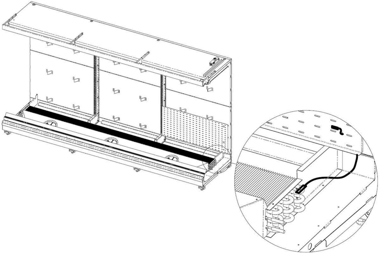
16. Пространство между испарителем и спинкой базового модуля закрыть левой и правой перегородками. Закрепить перегородки при помощи саморезов 4.2x13 к базовому модулю согласно рисунку.
