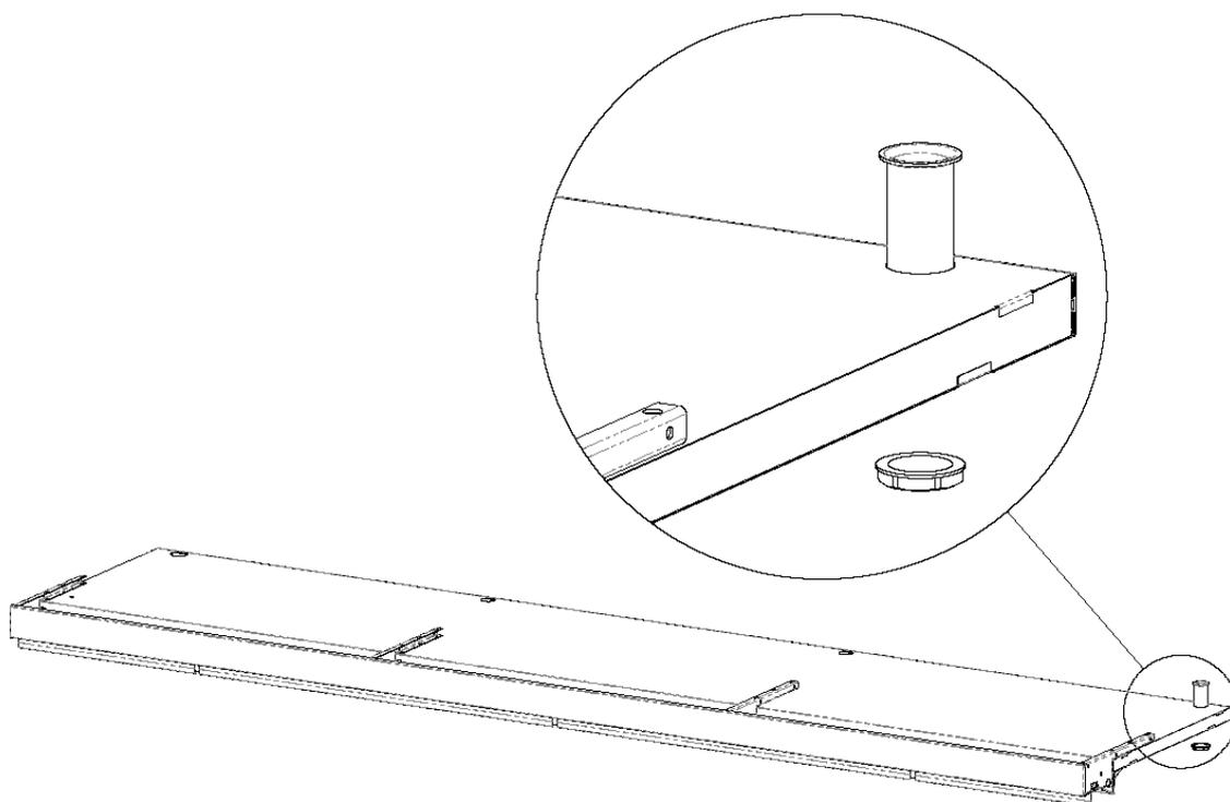
14. Согласно размерам, указанным на рисунке закрепить на крыше базового модуля при помощи саморезов 4.2x13 блок электроники и кабель-канал длиной 600мм.
