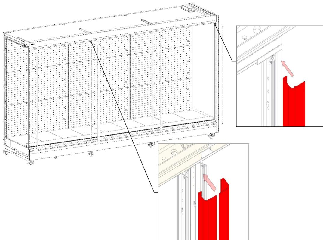
36. Установка панелей опоры. Установить верхнюю панель опоры. Закрепить черными саморезами 4.2x13 через верхний ряд отверстий.
