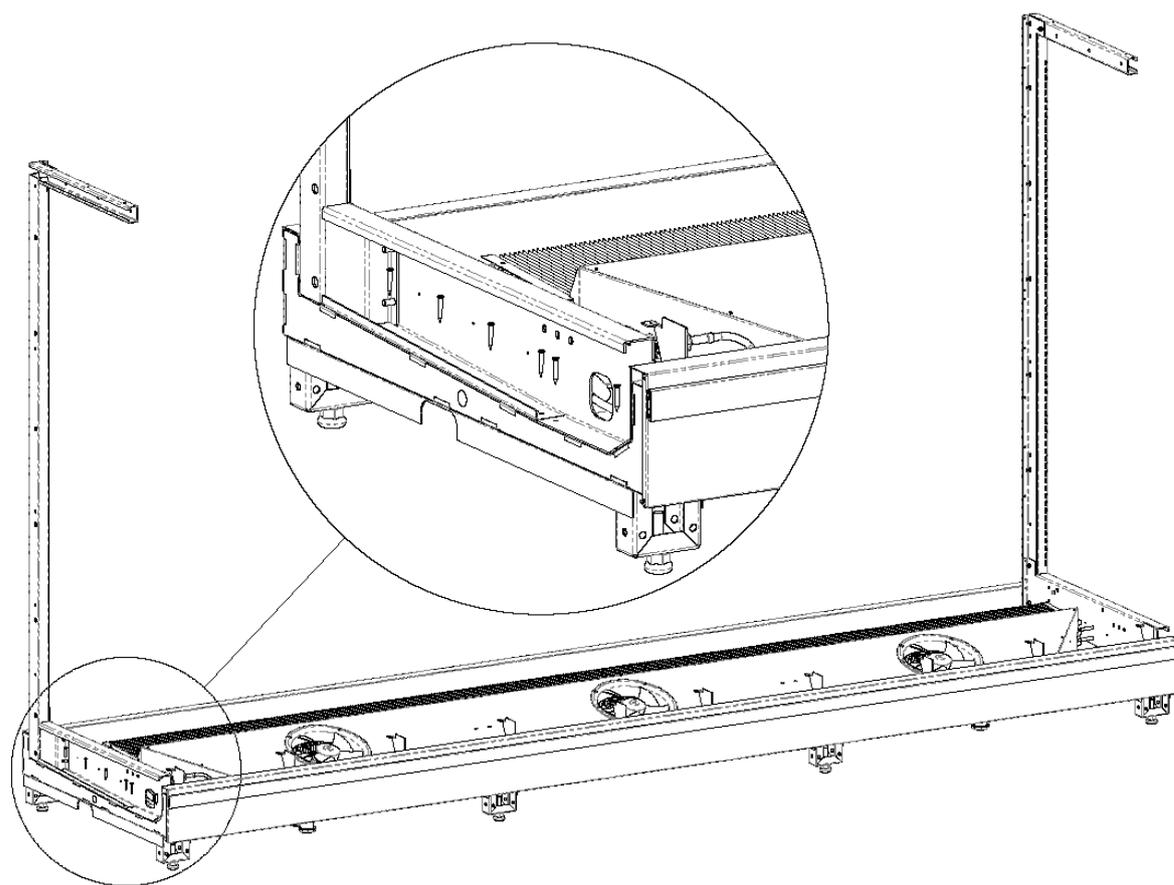
8. Установить на кронштейны и носик базового модуля вентиляционную панель. Закрепить вентиляционную панель при помощи саморезов 4.2x13 через отверстия, выровняв вентиляционную панель по длине с фронтальной.
