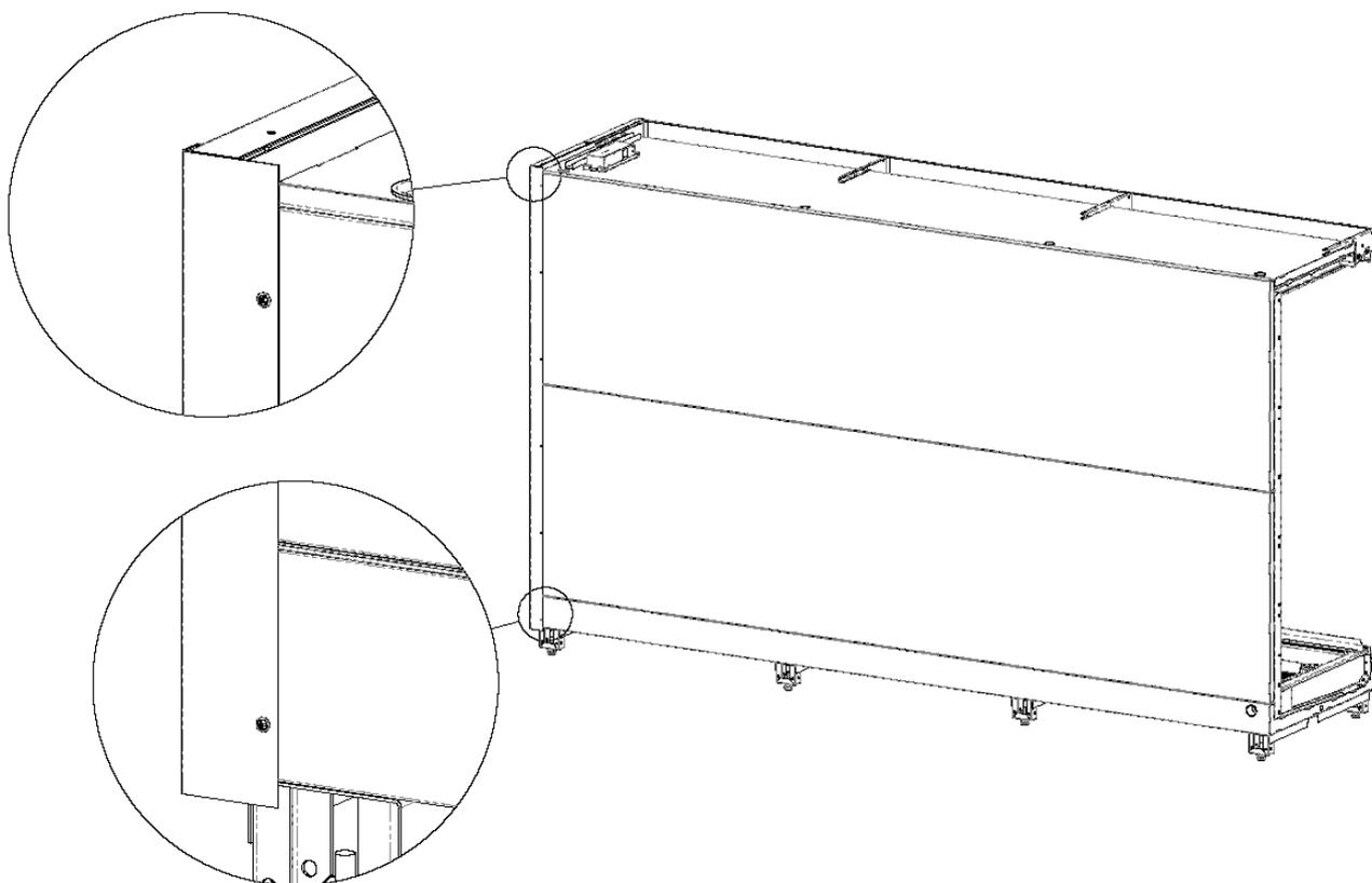
22. Освободить от пены отверстие  $\phi 12$  мм в крыше витрины. Прокинуть датчик с проводом от ЖК-термометра через отверстие во внутренний объем витрины и закрепить при помощи самоклеящегося хомута на внутреннем листе крыши. Заглушить отверстие в крыше герметиком-замазкой.
