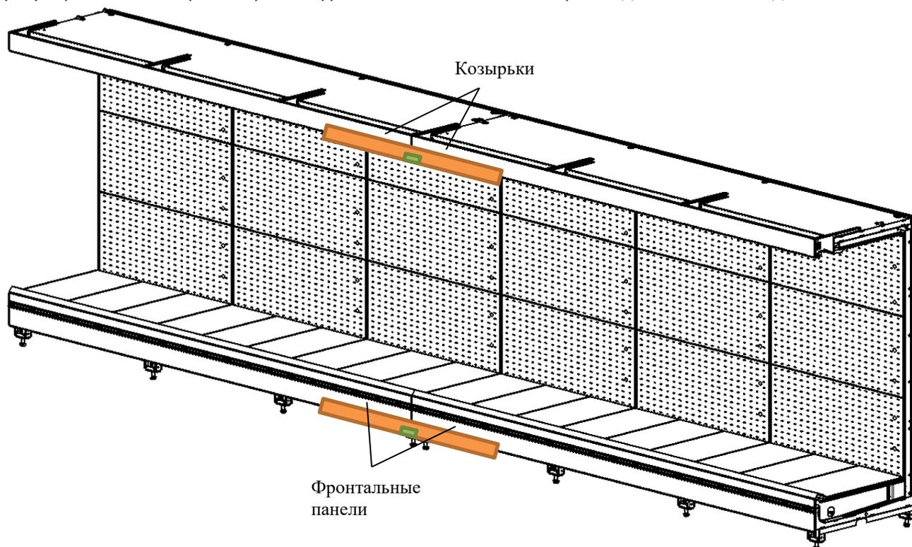
4. Стянуть витрины между собой при помощи метизов из комплекта поставки, так чтобы между торцами козырьков и фронтальных панелей стыкуемых витрин не было зазоров:
