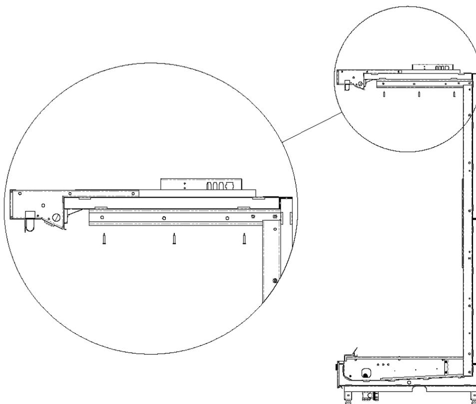
15. Закрепить к спинке базового модуля, рядом с правой стойкой при помощи саморезов 4.2x13 пластиковый кабель-канал 40x25x1600мм.
