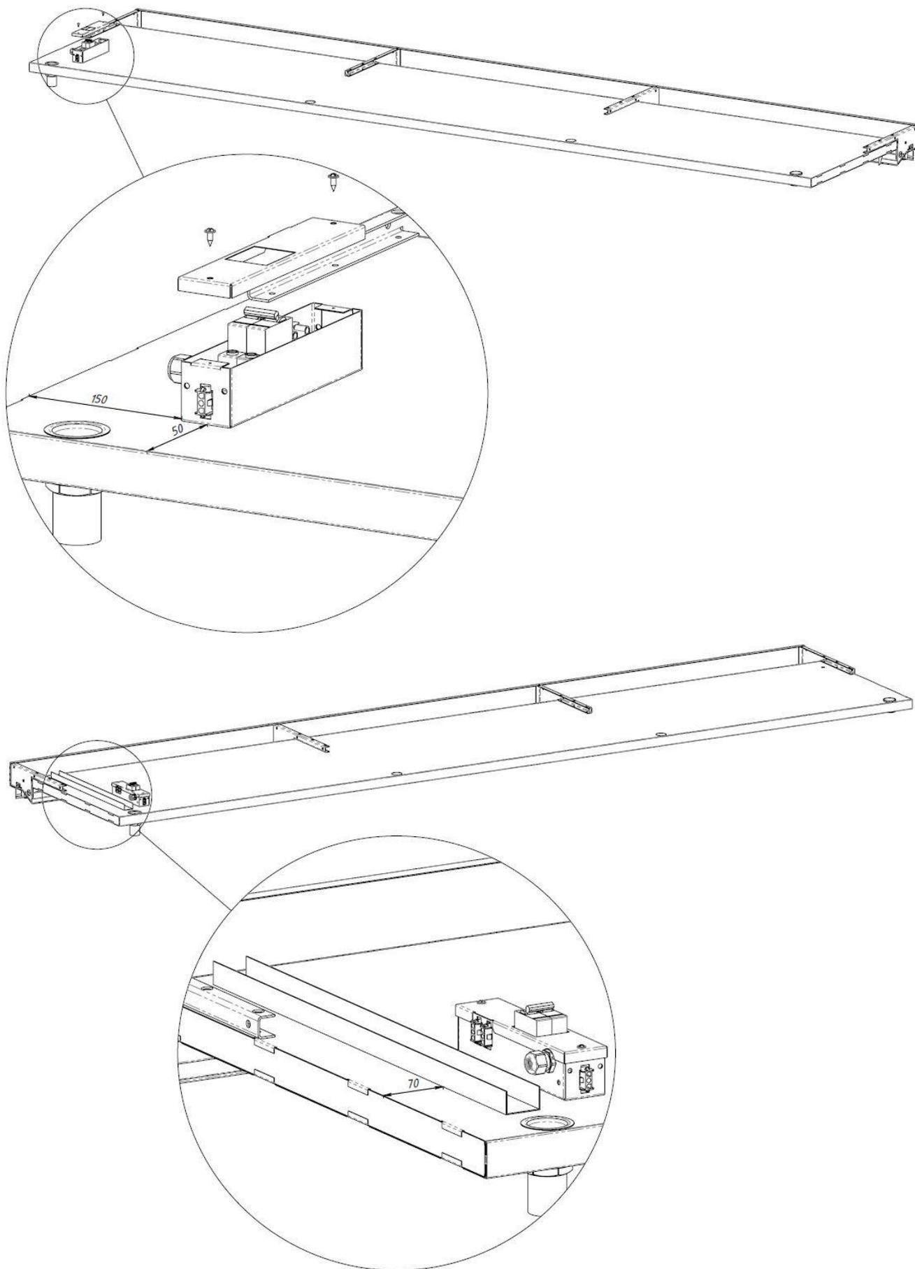
Проклеить торец крыши базового модуля поролоновой лентой 30х6. Установить крышу в сборе на верхние кронштейны стоек. Выровнять крышу по длине со спинкой базового модуля. Прижать проклеенный торец крыши к спинке. Закрепить крышу саморезами 5х35 через отверстия в верхних кронштейнах средних и боковых стоек. Стык между спинкой и крышей промазать герметиком снаружи и изнутри. Снаружи проклеить стык алюминиевой лентой, входящей в комплект поставки.
