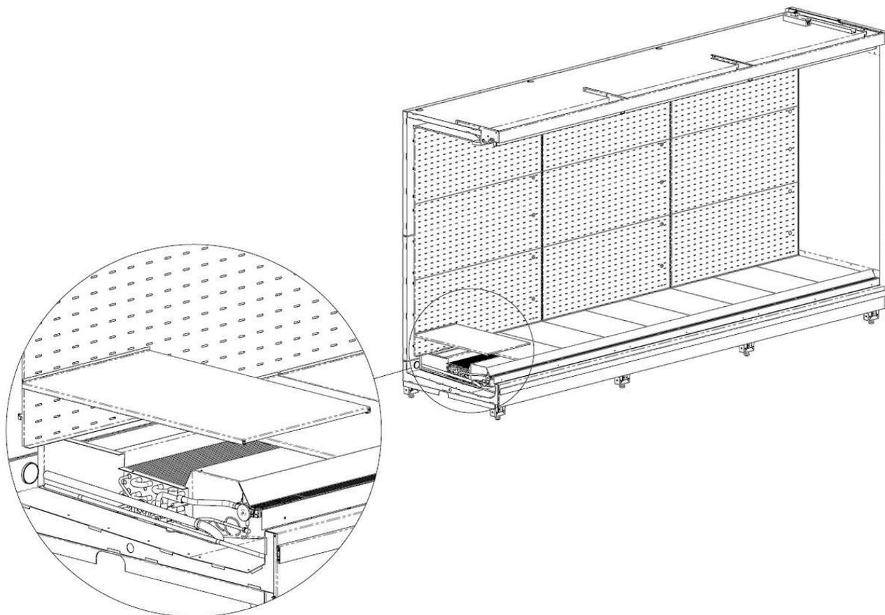
28. Установка фронтальных рам и дверей. В проем витрины между козырьком и фронтальной панелью установите рамы CISA 1250x1854мм.
