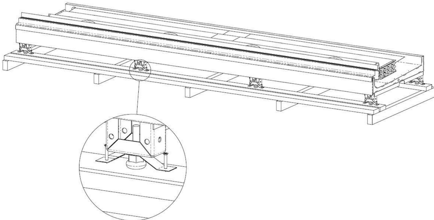
3. Выкрутить регулировочные ножки, снять транспортировочные пластины, вкрутить ножки обратно.
