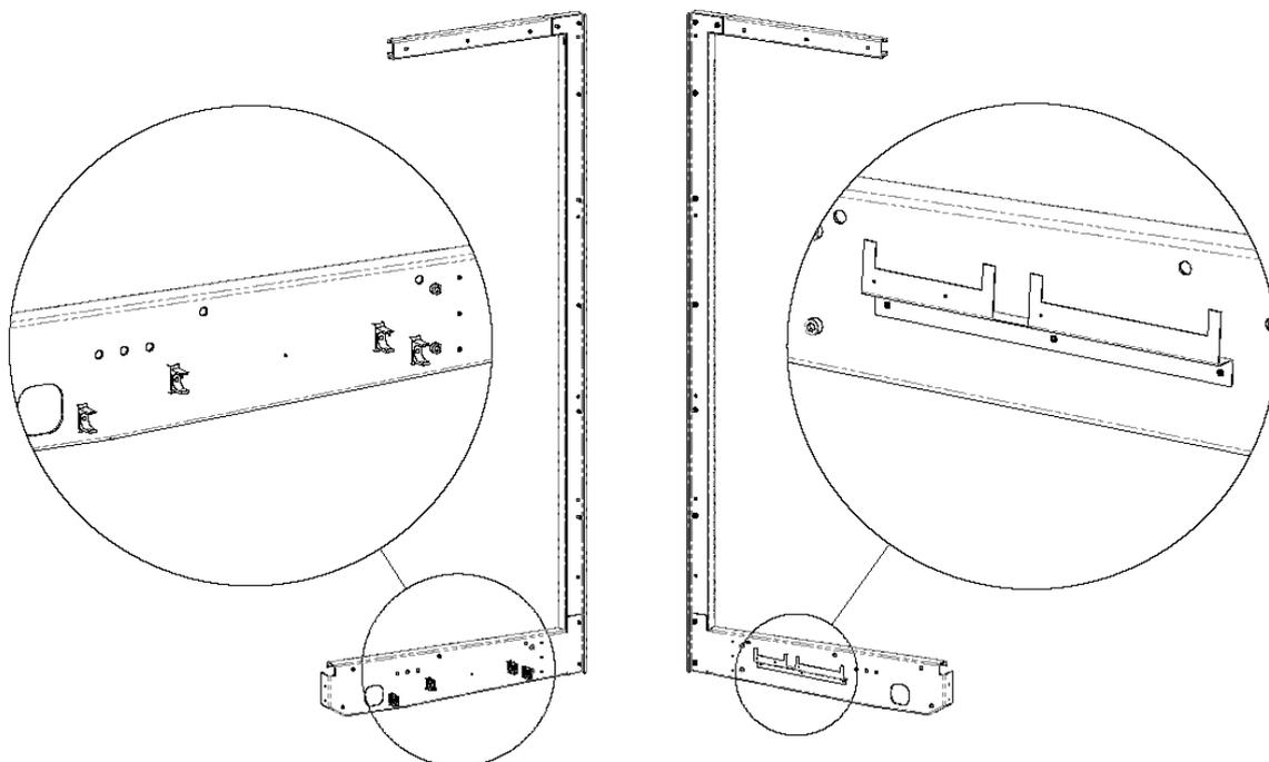
7. Нанести на места установки стоек, отступив от краев базового модуля 10-15 мм, силиконовый герметик. Выровнять нижние кронштейны стоек по торцам базового модуля и закрепить их при помощи саморезов 5x35 к модулю.
