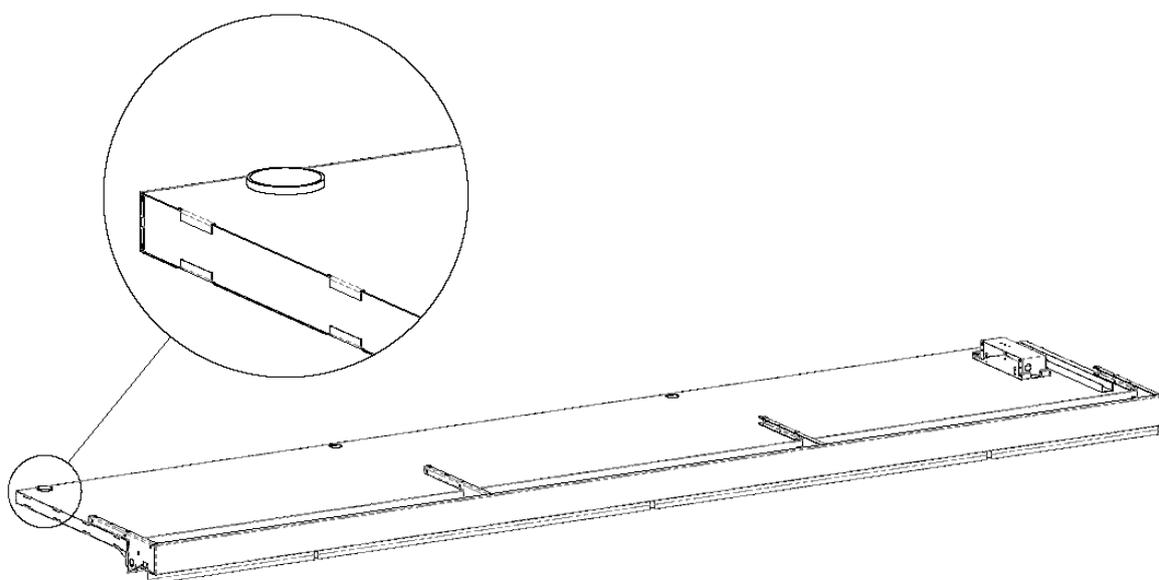
6. Закрепить по разметке при помощи саморезов 4.2x13 к нижним левому и правому кронштейнам стоек угловую защиту кабеля и раздвижные пластиковые держатели соответственно.
