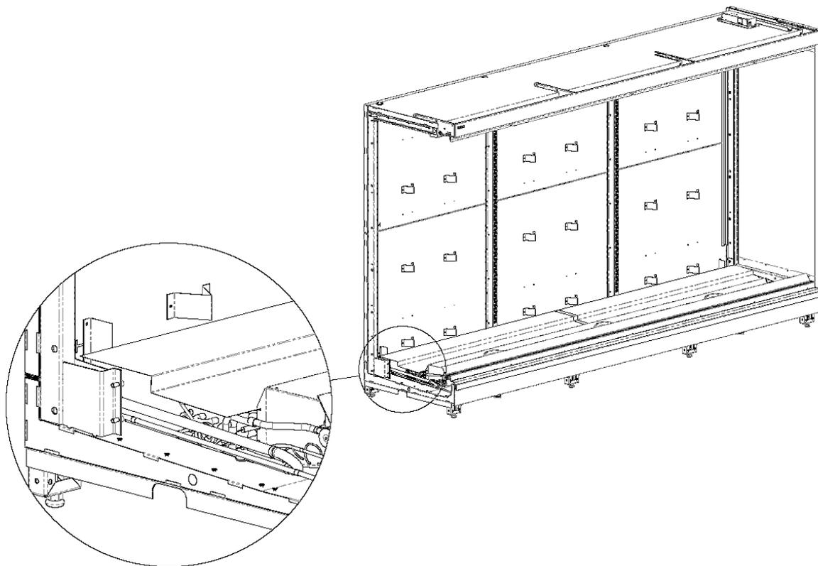
26. Установка задних перфорированных стенок и упоров. Установка осуществляется путем заведения зацепов перфорированной стенки в вырезы стоек. Установку стенок начинать с нижнего вида.
