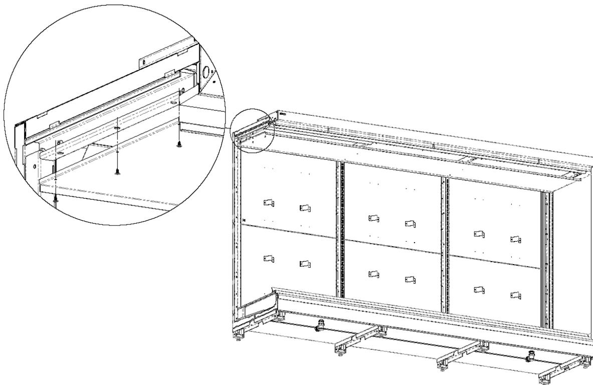
24. Установить в проём между панелью потолка и плафоном светильника сотовые панели. Завести один край сотовой панели в отгиб плафона светильника. Слегка отжав панель потолка от верхней траверсы, заправить сотовую панель в паз панели потолка. Закрутить саморезы 4.2x13 со сверлом.
