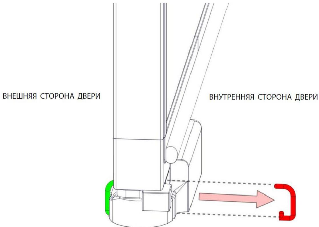
Наружный фиксатор удалить после установки двери.
