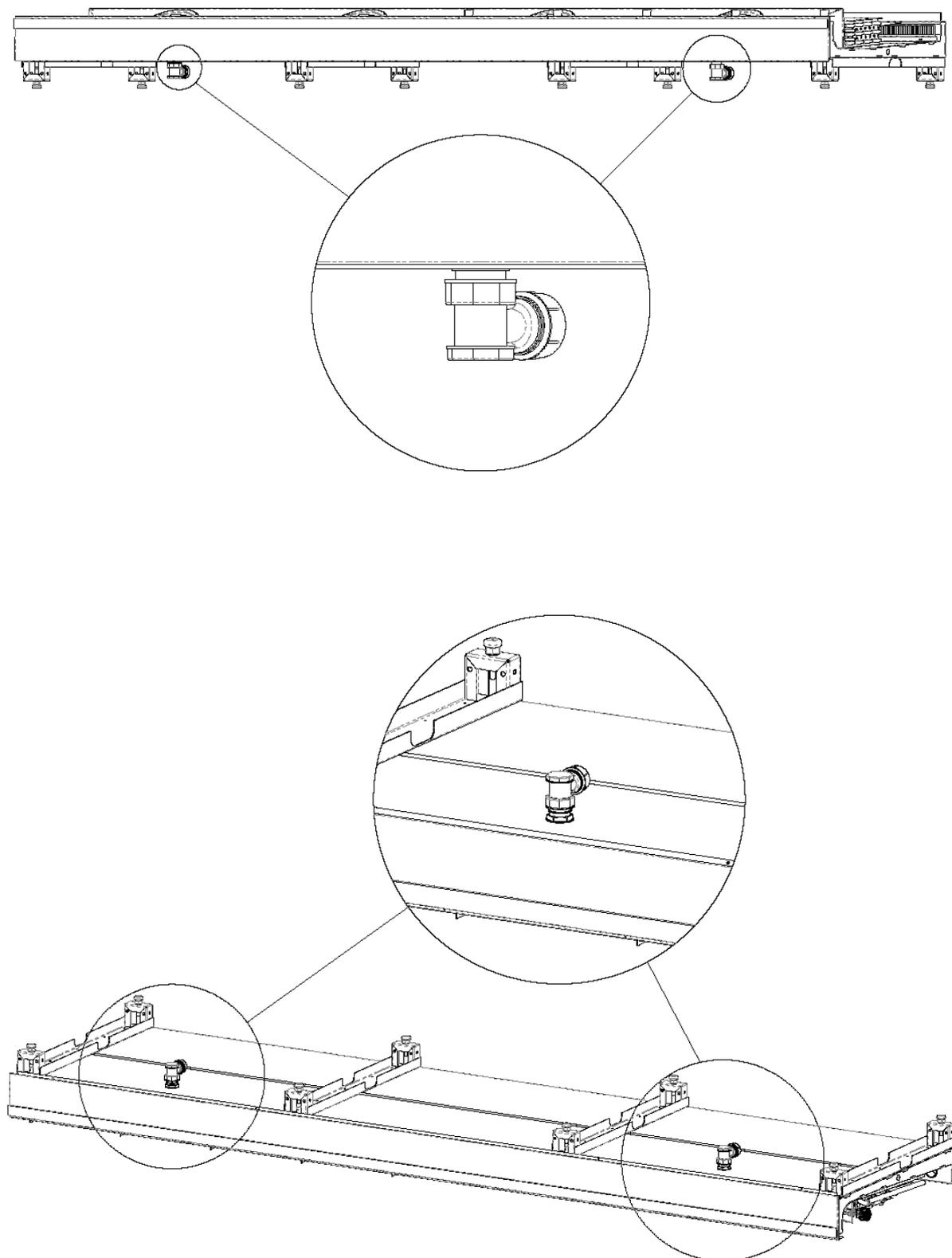
5. **В зависимости от места вывода труб испарителя** освободить от пены отверстие  $\text{Ø}50\text{мм}$  в задней стенке базового модуля или в крыше витрины. Место контакта модуля с гильзой промазать силиконовым герметиком. Герметик входит в комплект поставки. Установить в отверстие гильзу  $\text{Ø}50\text{мм}$  согласно рисунку. Гильза входит в комплект поставки.
