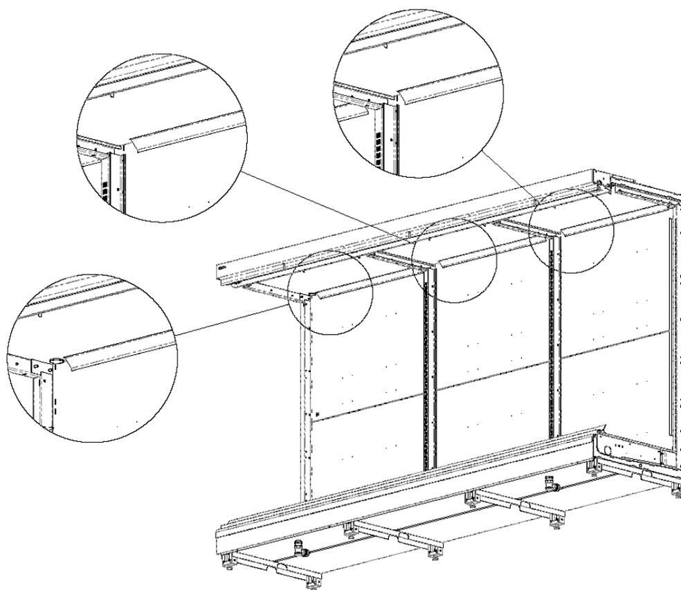
17. Согласно разметке закрепить на спинке витрины при помощи заморезов 4.2x13 ограничители перфорированных стенок.
