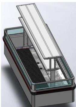
6. Закрепить стойки к боковинам саморезами по отверстиям в стойках.
