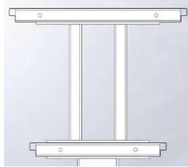
14. Установить заглушки торцевые на полки 300 и 400 на саморезы 4,2x13 оц.
