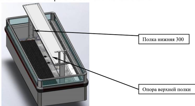
4. На верхней полке (400 мм) выведен кабель освещения верхней полки. Кабель нужно протянуть через трубу опоры верхней полки и закрепить опору к верхней полке болтами из комплекта.
