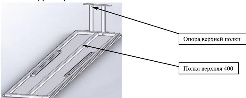
5. Установить верхнюю полку, протянув кабель освещения верхней полки через соответствующее отверстие в нижней полке, закрепить болтами из комплекта.
