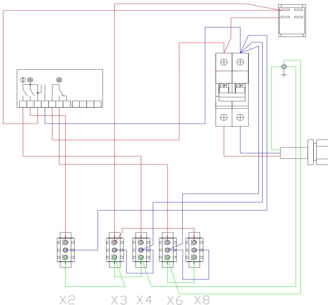
$X_2 (X_{2,1} - X_{2,2})$  – трехконтактный разъем подключения компрессора
