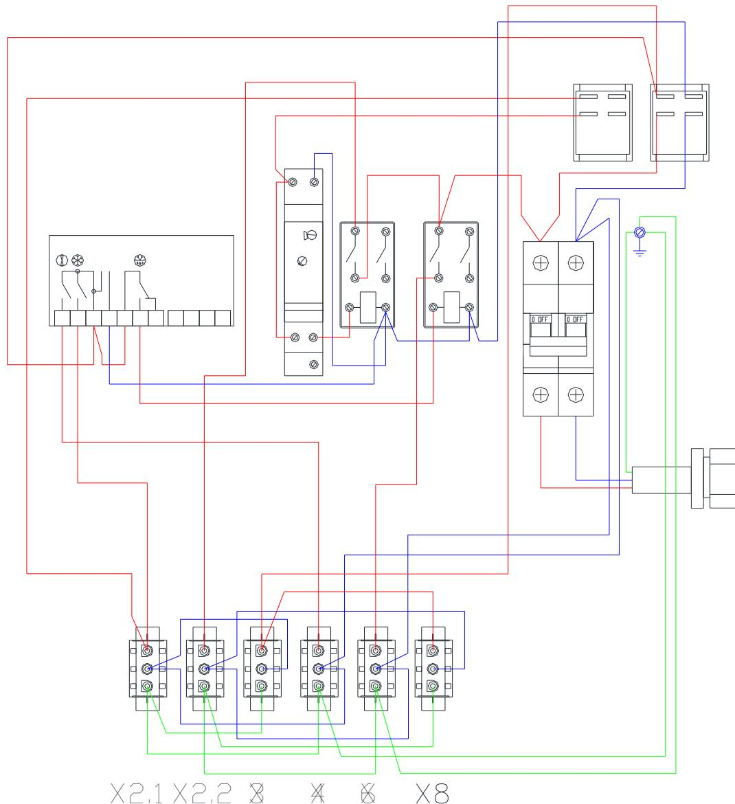
X2 (X2,1 – X2,2) – трехконтактный разъем подключения компрессора
