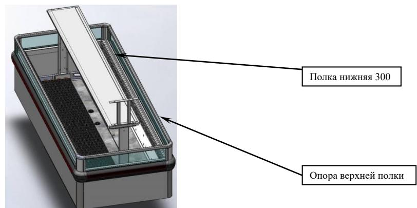
4. На верхней полке (400 мм) выведен кабель освещения верхней полки. Кабель нужно протянуть через трубу опоры верхней полки и закрепить опору к верхней полке болтами из комплекта.
