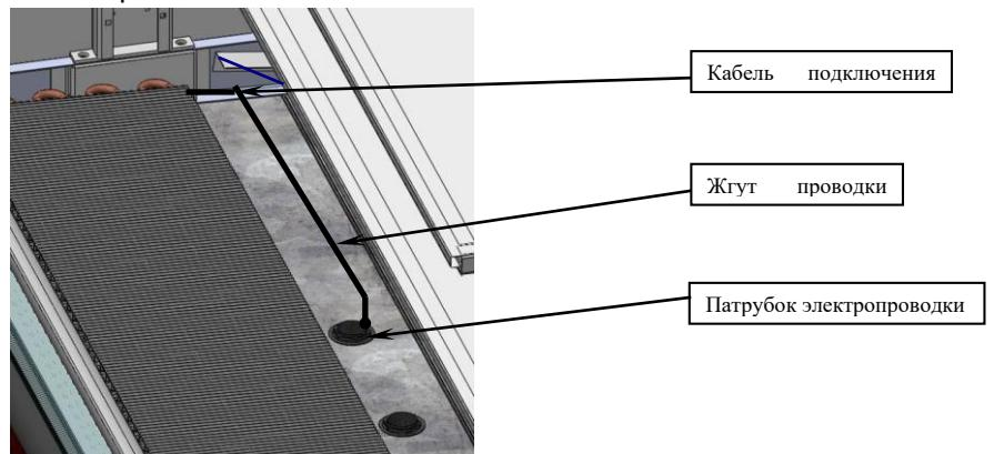
12. Установить на стойку у левой боковины панель декоративную стойки на нерж. саморезы 3,9x13 из комплекта, предварительно подключив провод электронагревательный, закрепленный на обратной стороне панели, и кабель освещения верхней полки к основному кабелю суперструктуры (разъемы папа-мама).
