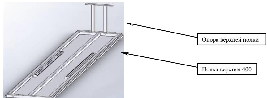
5. Установить верхнюю полку, протянув кабель освещения верхней полки через соответствующее отверстие в нижней полке, закрепить болтами из комплекта.
