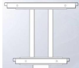
14. Установить заглушки торцевые на полки 300 и 400 на саморезы 4,2x13 оц.
