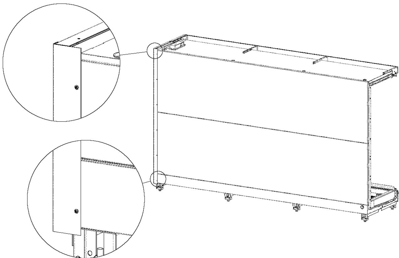
22. Освободить от пены отверстие ф12мм в крыше витрины. Прокинуть датчик с проводом от ЖК-термометра через отверстие во внутренний объем витрины и закрепить при помощи самоклеящегося хомута на внутреннем листе крыши. Заглушить отверстие в крыше герметиком-замазкой.
