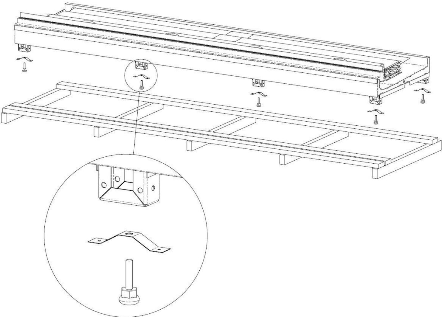
4. Установить на патрубки базового модуля сифоны слива, которые входят в комплект поставки. Поставить модуль витрины на ножки. Выровнять его по горизонтали посредством регулировки ножек. Проверить выравнивание с помощью уровня.
