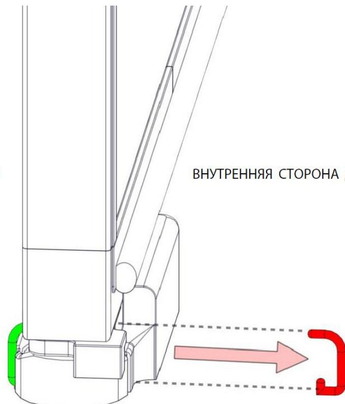
Наружный фиксатор удалить после установки двери.
