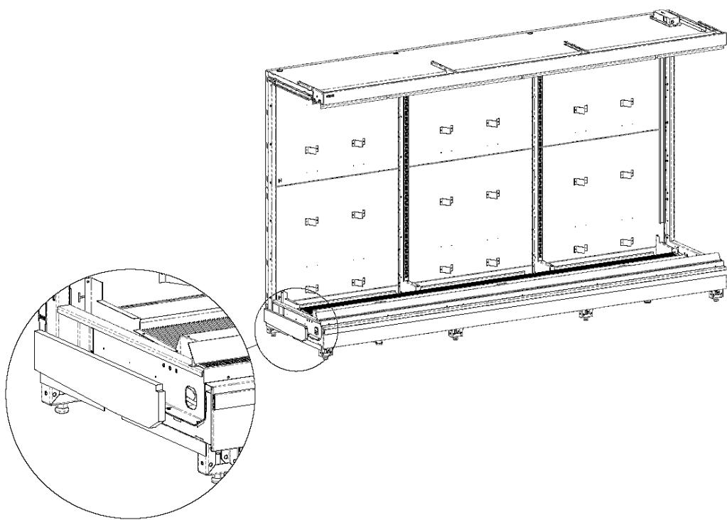
**Установка полнопрофильной боковины с зеркалом.** Боковина крепится при помощи саморезов 5x60 и шайб 6x18 через отверстия в боковых стойках. (Изображена правая боковина).
