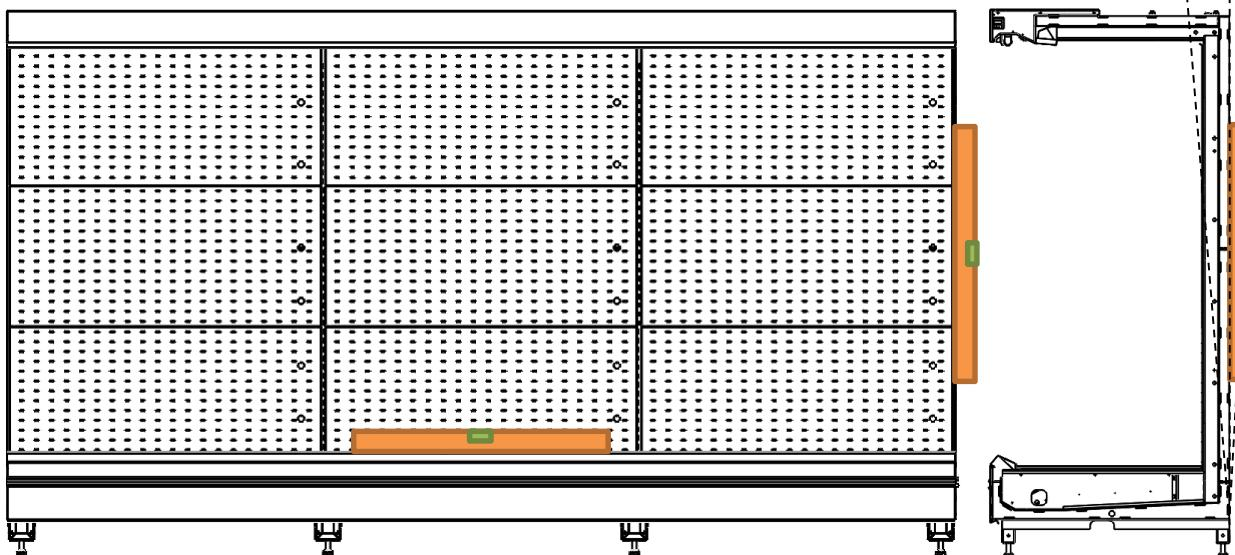
3. Придвинуть вторую стыкуемую витрину к первой (установленной по уровню) и выровнять при помощи регулировочных опор. Козырьки и фронтальные панели на витринах должны быть в одной плоскости.
