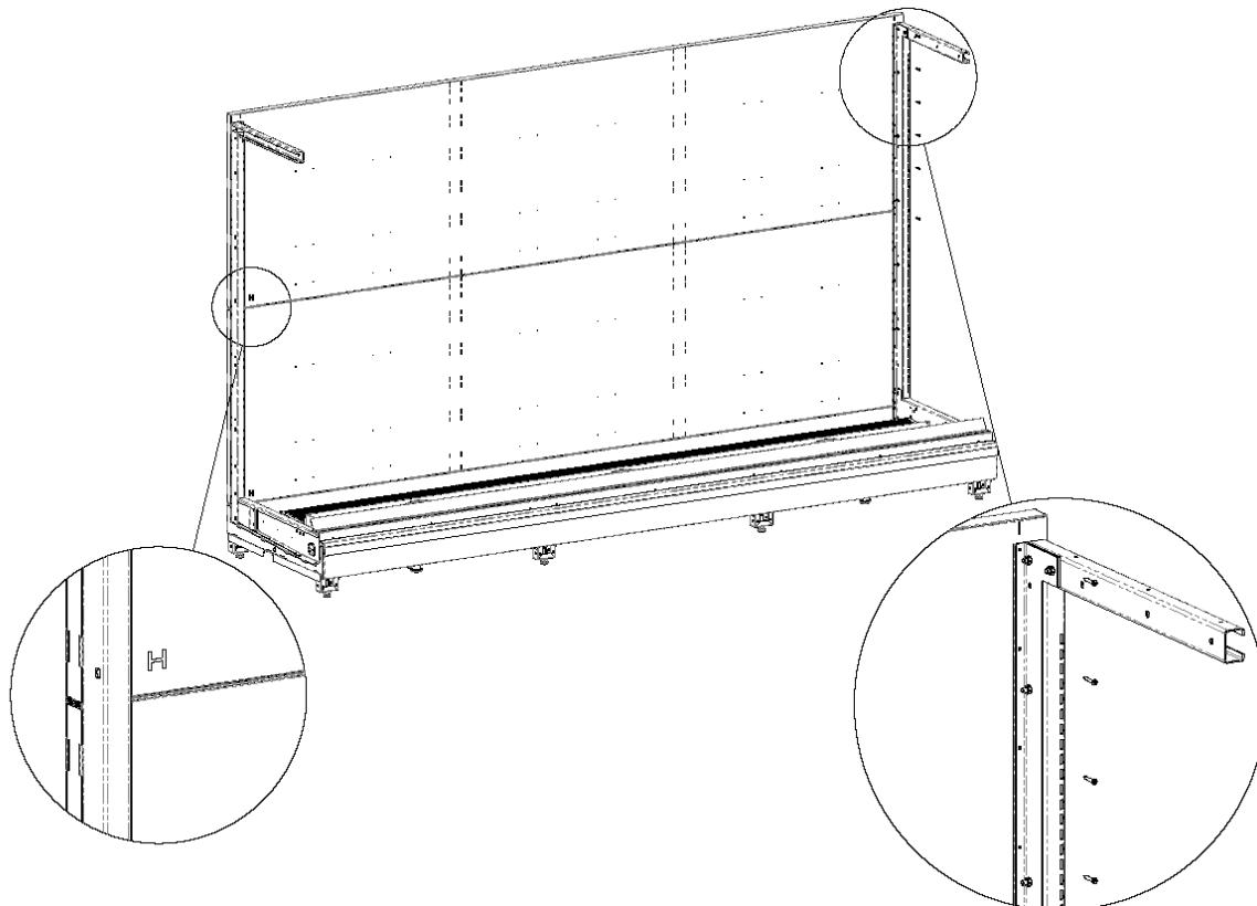
11. Монтаж центральных стоек. В качестве шаблона для установки и позиционирования центральных стоек использовать задние перфорированные стенки, зацепив их крючками за вырезы в стойках, учитывая расстояние 3-4 мм под дальнейшую установку кронштейнов полок. Закрепить центральные стойки к спинкам и базовому модулю при помощи саморезов 5x35.
