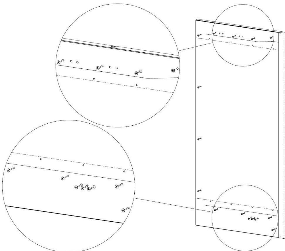
19. Позиционирование боковины произвести по нижней фронтальной панели (боковина должна выставляться на 1...3мм за декоративный бампер и быть на одной высоте с фронтальной панелью), верхнему декоративному козырьку (боковина должна выставляться за плоскость козырька на 7...9мм и быть с ним и на одной высоте), спинке витрины (торец боковины должен быть параллелен спинке витрины).
