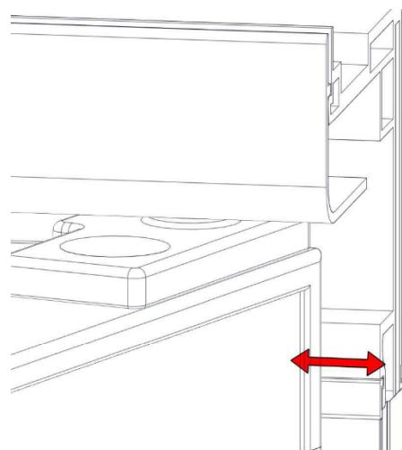
РАСПОЛОЖЕНИЕ И РАБОТУ ДВЕРЕЙ НЕОБХОДИМО ПРОВЕРИТЬ НА ВИТРИНЕ, ЗАГРУЖЕННОЙ ПРОДУКТОМ!
