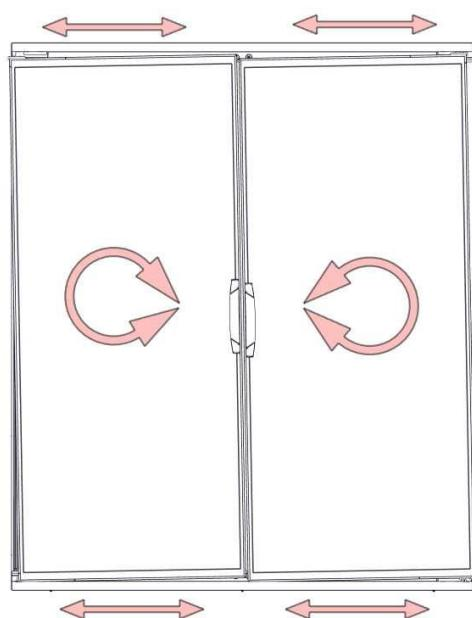
Проверьте расстояния между дверью и краем рамы. При необходимости отрегулируйте расстояние.
