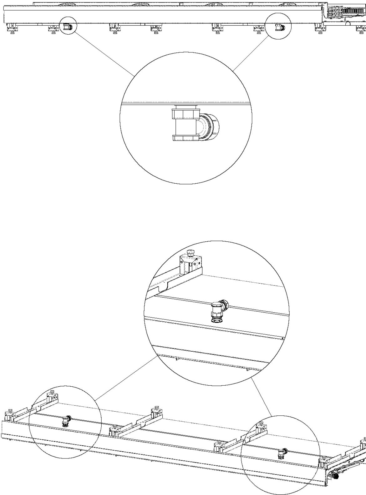
5. **В зависимости от места вывода труб испарителя** освободить от пены отверстие Ø50мм в задней стенке базового модуля или в крыше витрины. Место контакта модуля с гильзой промазать силиконовым герметиком. Герметик входит в комплект поставки. Установить в отверстие гильзу Ø50мм согласно рисунку. Гильза входит в комплект поставки.
