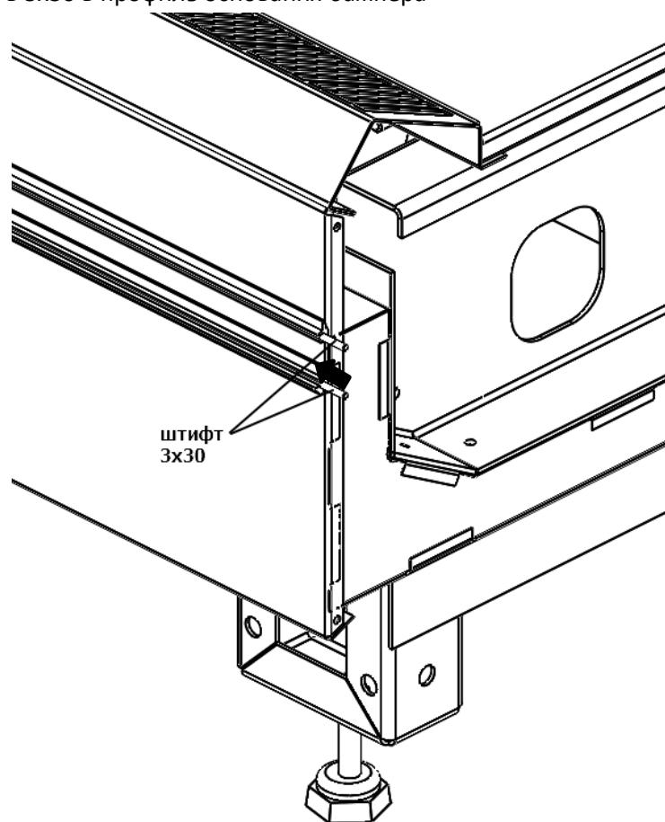
2. Выставить первую витрину в линейке по уровню при помощи регулируемых опор.
