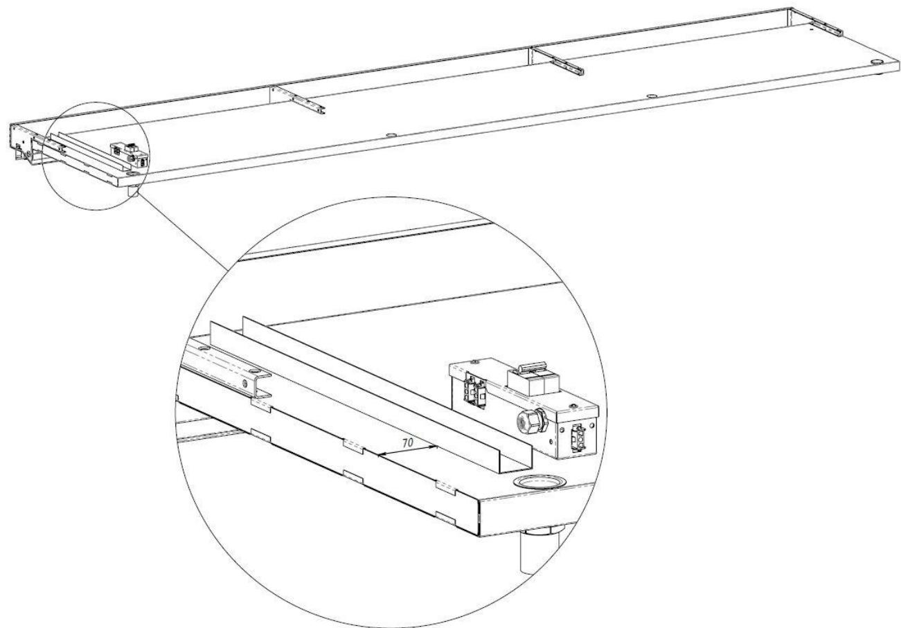
Проклеить торец крыши базового модуля поролоновой лентой 30х6. Установить крышку в сборе на верхние кронштейны стоек. Выровнять крышку по длине со спинкой базового модуля. Прижать проклеенный торец крыши к спинке. Закрепить крышку саморезами 5x35 через отверстия в верхних кронштейнах средних и боковых стоек. Стык между спинкой и крышкой промазать герметиком снаружи и изнутри. Снаружи проклеить стык алюминиевой лентой, входящей в комплект поставки.
