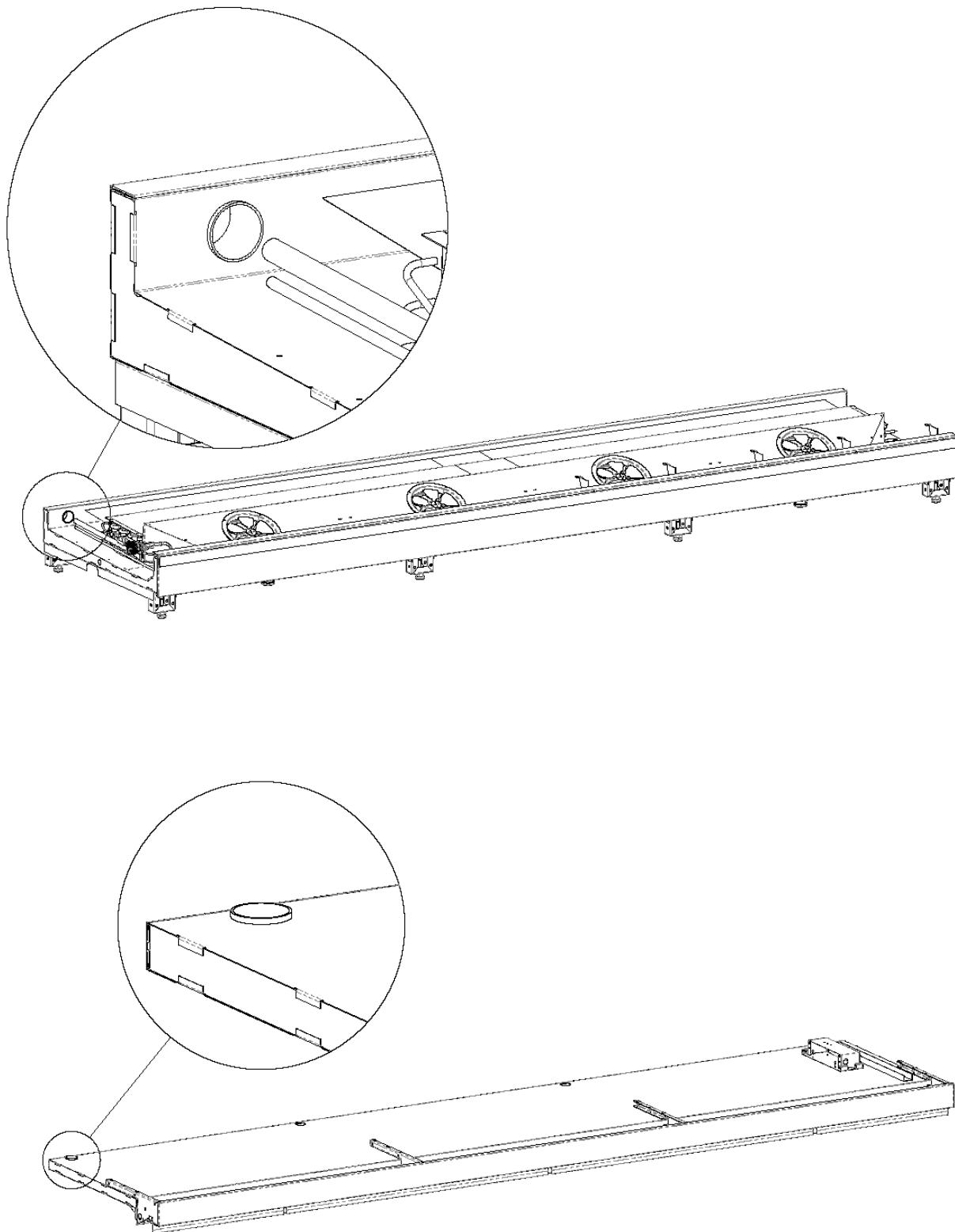
6. Закрепить по разметке при помощи саморезов 4.2x13 к нижним левому и правому кронштейнам стоек угловую защиту кабеля и раздвижные пластиковые держатели соответственно.
