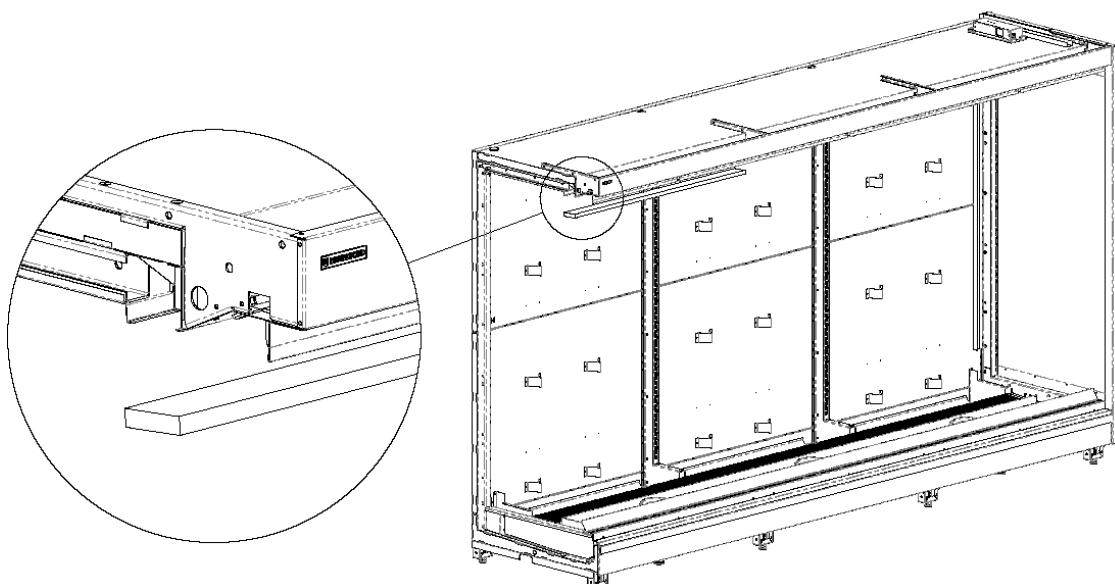
25. Установить на опоры центральных стоек, перегородки и испаритель два экрана испарителя. Завести экраны длинной стороной под панель вентиляторов. Экраны установить в притык к нижним траперсам боковых стоек.
