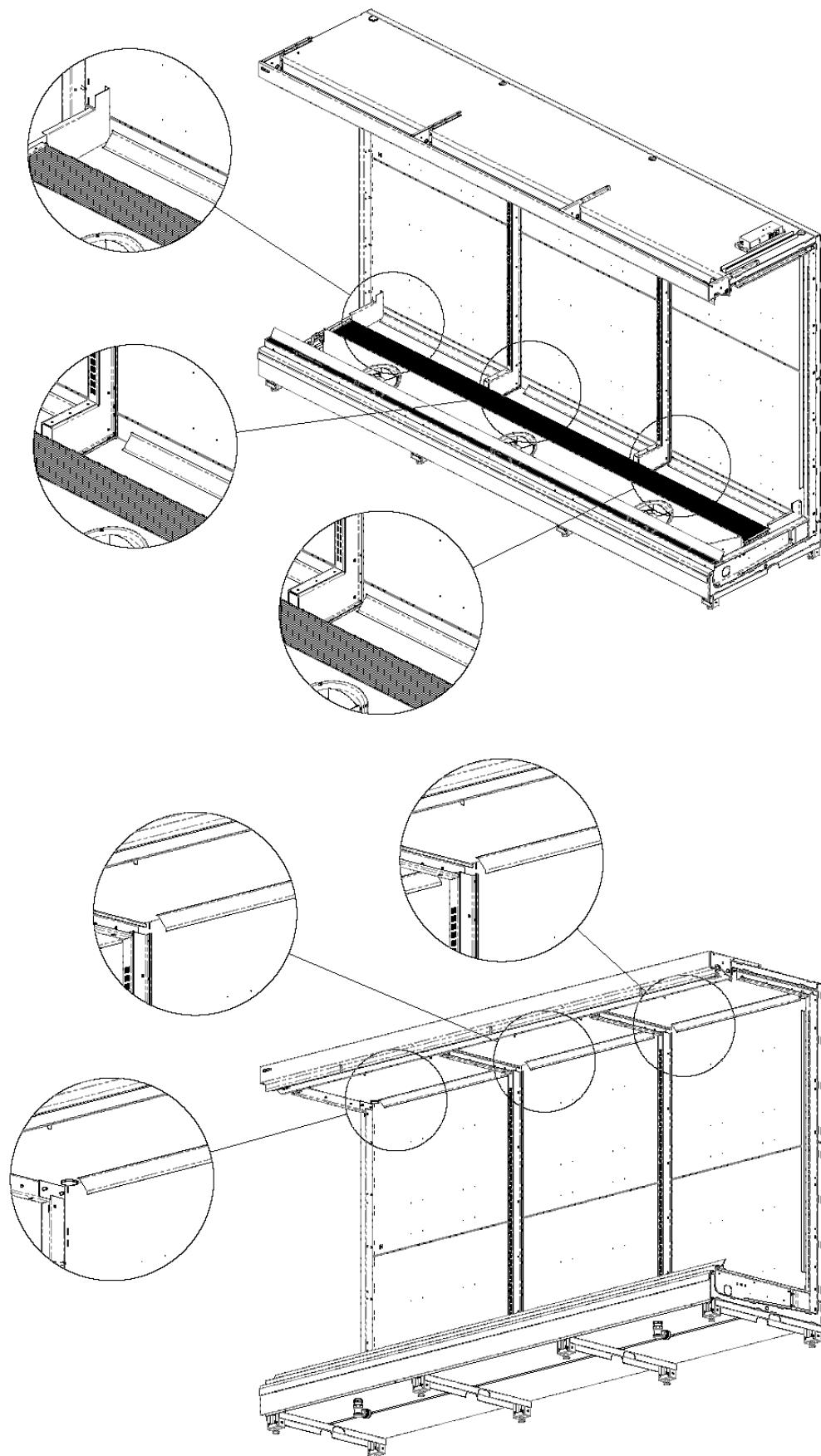
17. Согласно разметке закрепить на спинке витрины при помощи заморезов 4.2x13 ограничители перфорированных стенок.
