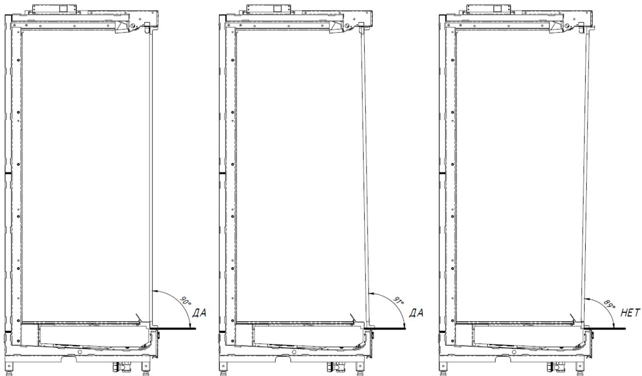
29. Зафиксируйте верхний и нижний профиль рамы при помощи саморезов 4.2x19 из комплекта поставки.
