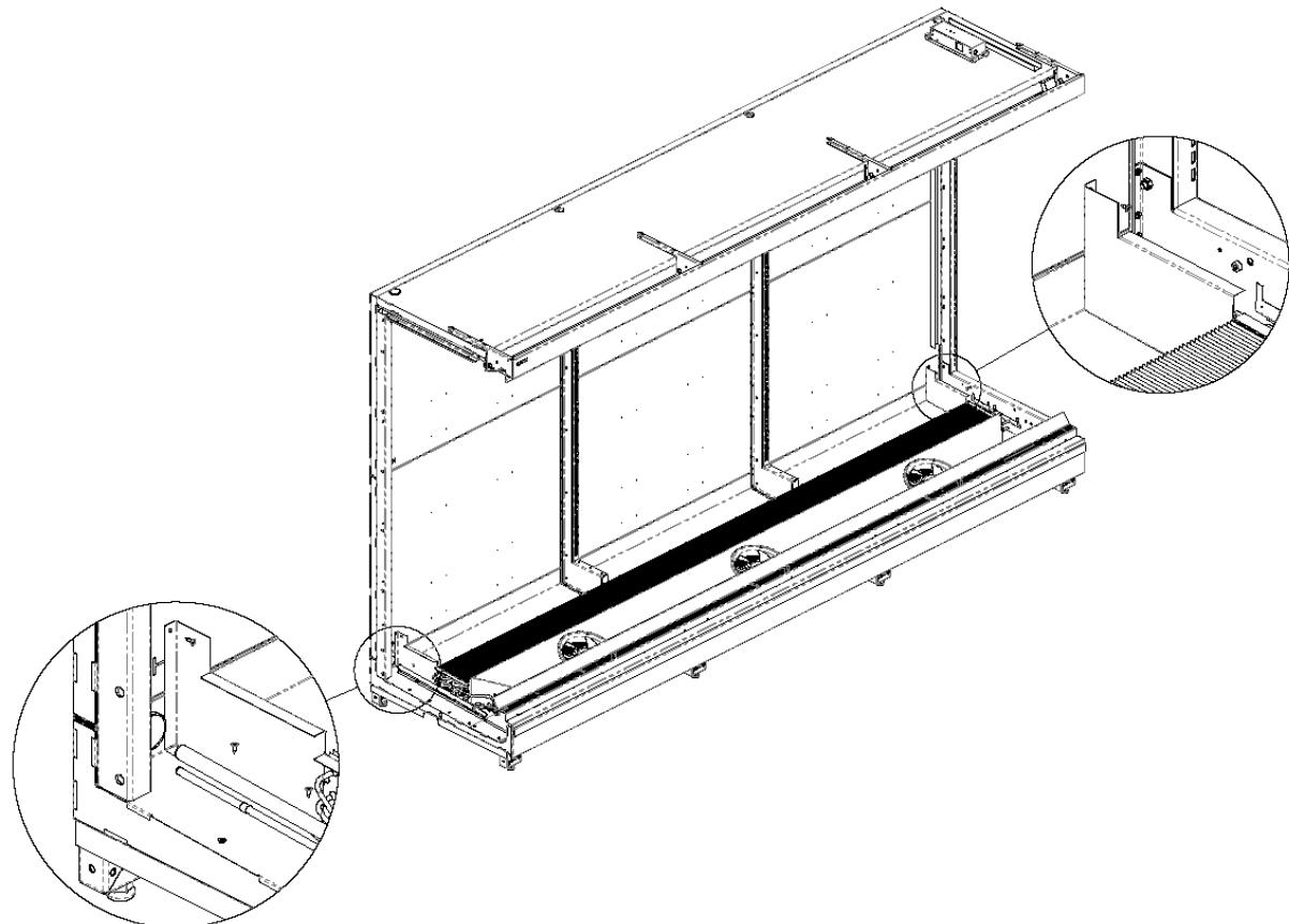
Установить во внутренний угол базового модуля и угол между спинкой и крышей витрины отбойники воздушного потока и закрепить их при помощи саморезов 4,2x13.
