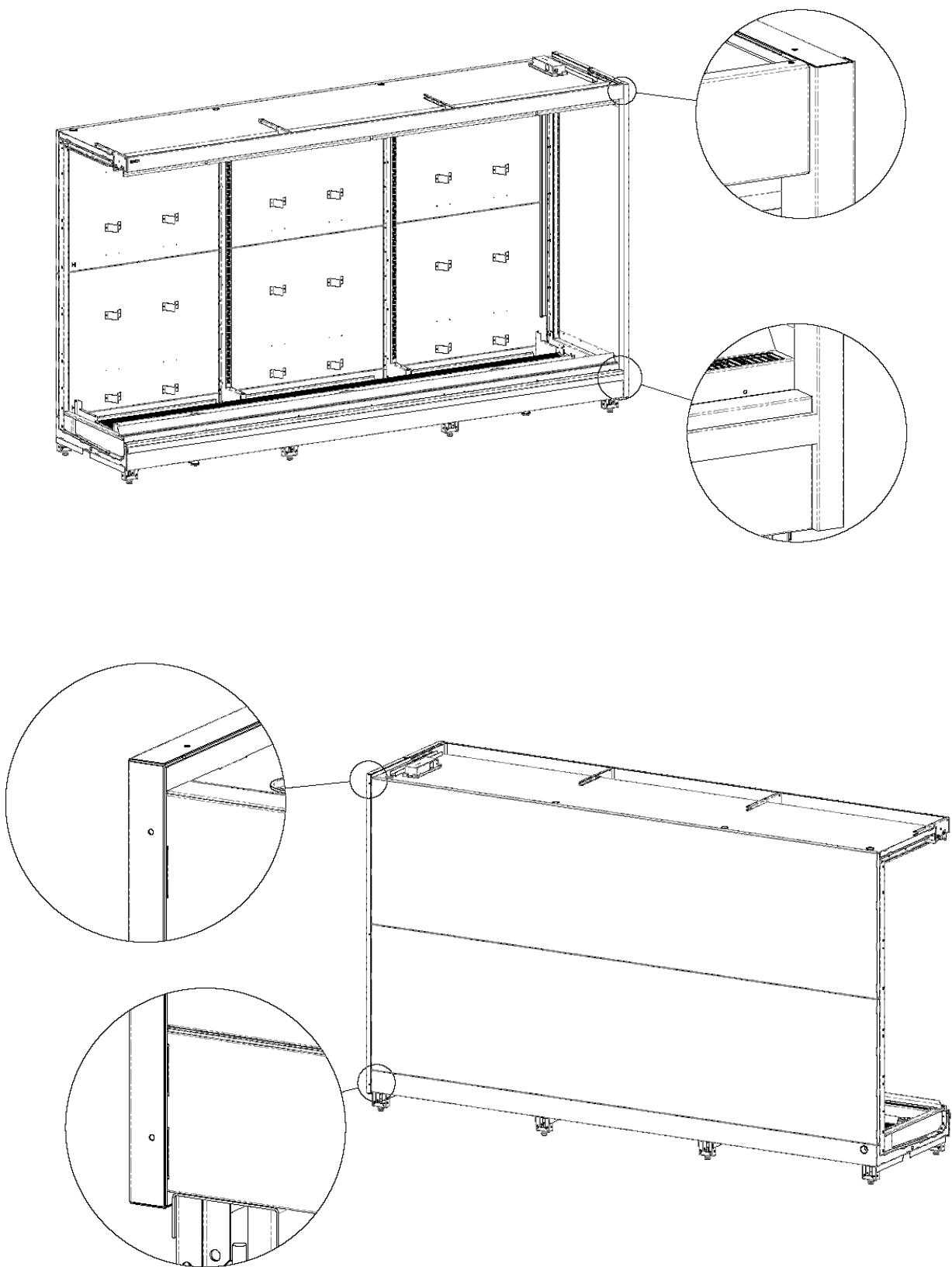
20. Закрепить боковину при помощи саморезов 5x60 и шайб 6.4x18 через отверстия в стойках, верхних и нижних кронштейнах. Крепление боковины к верхнему козырьку осуществляется саморезом 4.2x19 через шайбу 6.4x18.
