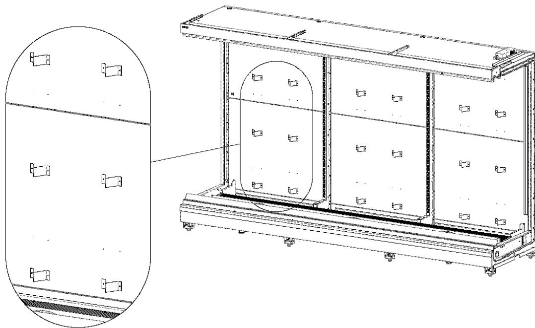
18. Обклейте торцы базового модуля, спинок и крыши поролоновой лентой 30х6, входящей в комплект поставки. Установить в нижние кронштейны стоек противоконденсатные вставки (из пенопласта), входящие в комплект поставки. Нанести силиконовый герметик на торцы базового модуля, спинок и крыши.
