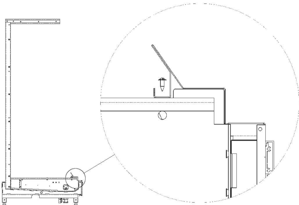
9. Обклейте торец базового модуля поролоновой лентой 30х6, входящей в комплект поставки. Установить нижнюю спинку базового модуля на торец модуля. Буква **Н** при этом должна оказаться в нижнем левом углу, рядом с левой стойкой. Выровнять спинку по длине относительно базового модуля. Согласно разметке закрепить нижнюю спинку к стойкам при помощи саморезов 5x35.
