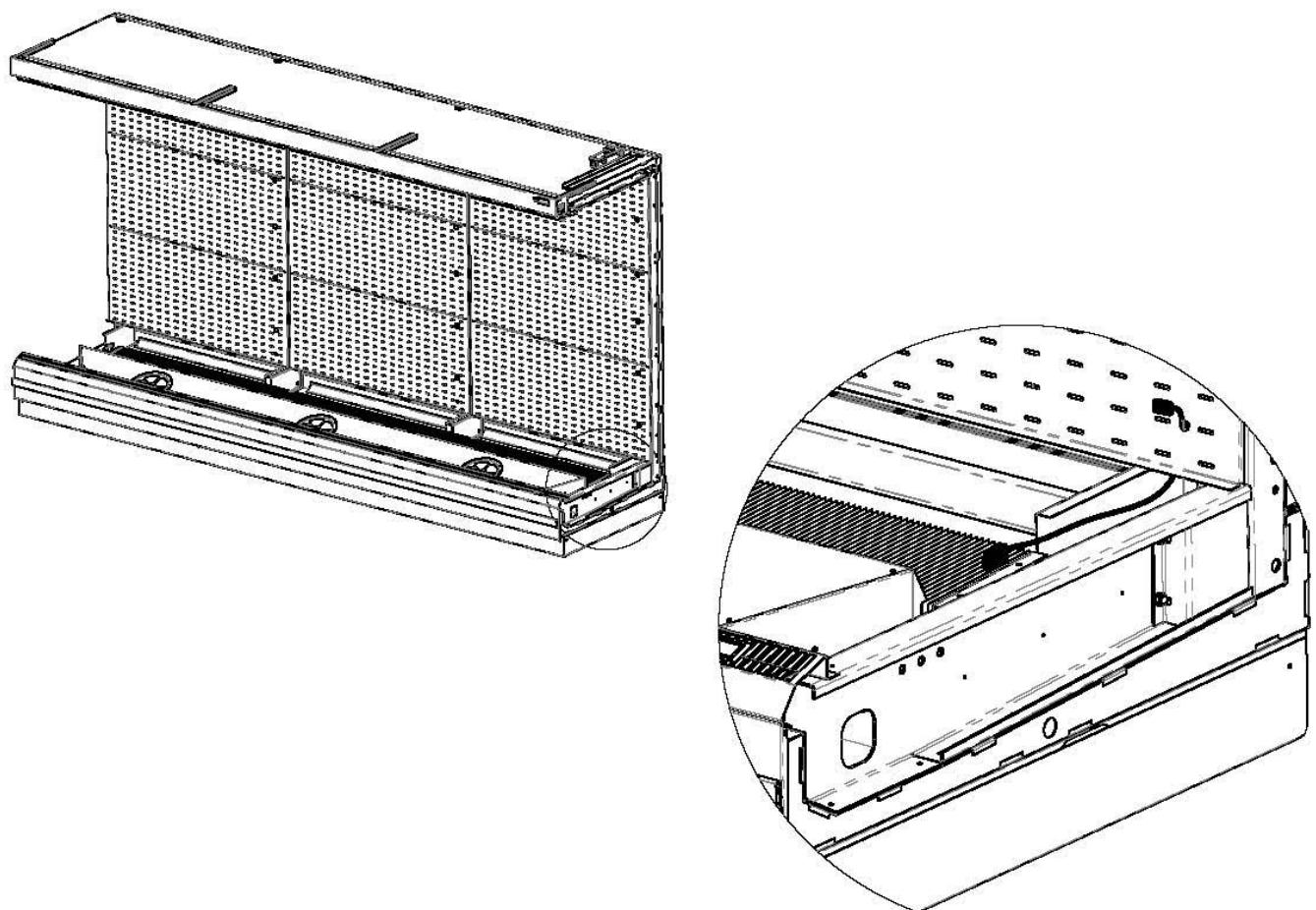
16. Пространство между испарителем и спинкой базового модуля закрыть левой и правой перегородками. Закрепить перегородки при помощи саморезов 4.2x13 к базовому модулю согласно рисунку.
