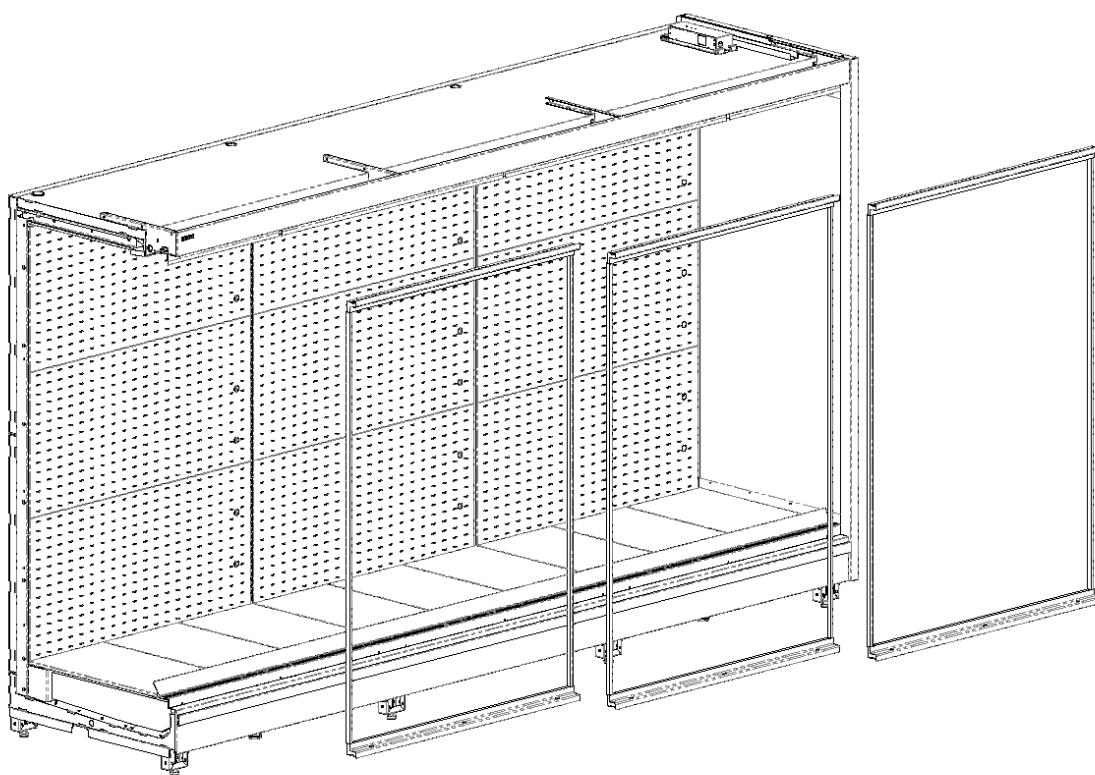
Все диагонали рам должны быть равны. **A=B (+/- 2ММ)** Диагонали могут отличаться не более чем на 2мм. Любые искривления рамы необходимо исправить. Проверьте перпендикулярность рамы.
