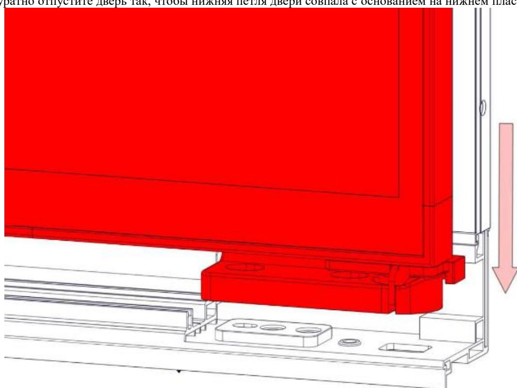
33. Закрепите нижнюю петлю на раме при помощи винтов M6X12 из соединительного комплекта.
