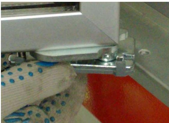
2. Вынуть фиксатор дверки.
