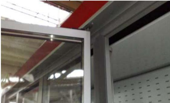
5. Вставить дверку с нижним фиксатором в раму.
